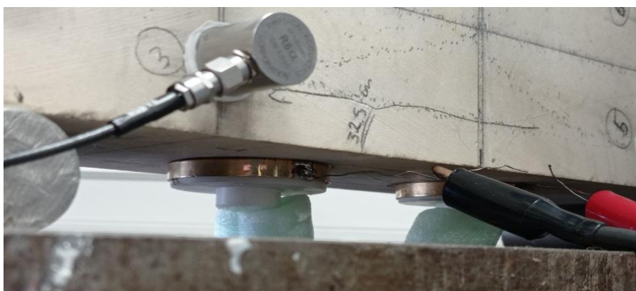
Εικόνα 23: Θέση ηλεκτροδίων ανίχνευσης PSC στην πειραματική διάταξη κάμψης τριών σημείων σε δοκίμιο υψηλού πορώδους.
