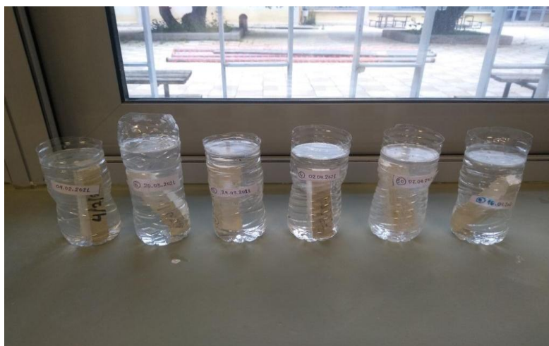
Εικόνα 20: Διαδικασία πλήρωσης των πόρων των δοκιμίων με νερό.
