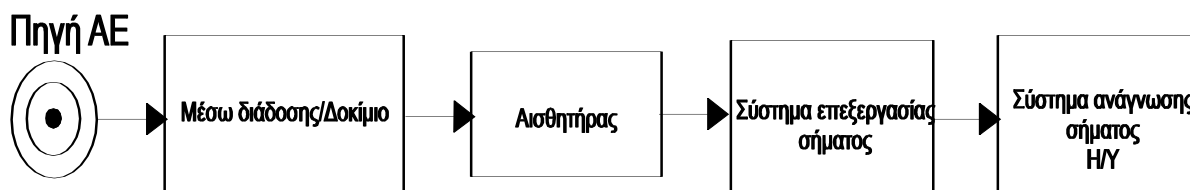
Σχήμα 8. Block διάγραμμα διάταξης ελέγχου και καταγραφής ΑΕ[15].
