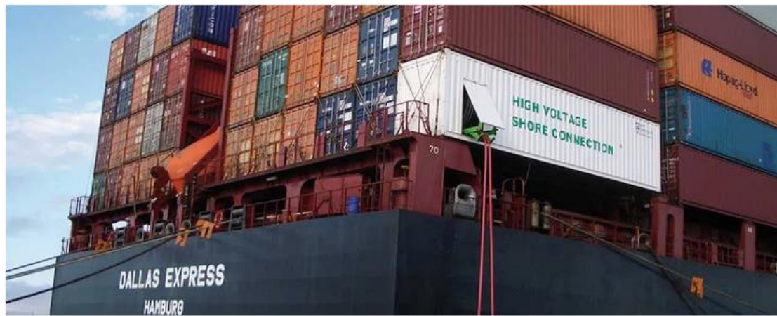
Εικόνα 3-12: Εγκατάσταση SAMCon σε πλοίο εμπορευματοκιβωτίων (Πηγή No. 31)
