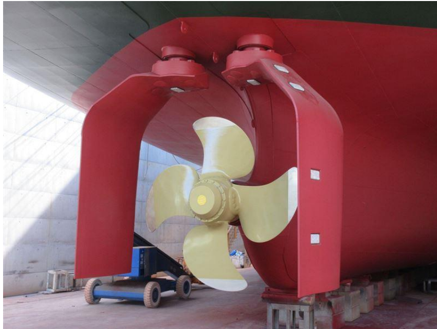
Εικόνα 3-4: Σύστημα Gate Rudder by Wartsila (Πηγή Νο. 34)
