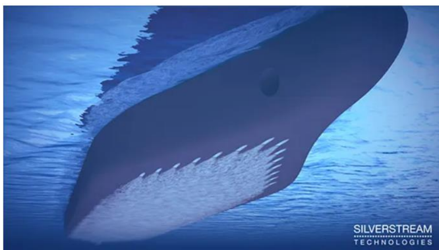
Εικόνα 3-1: Εικόνα γάστρας με χρήση συστήματος λίπανσης με αέρα σε λειτουργία (Πηγή Νο. 32)
