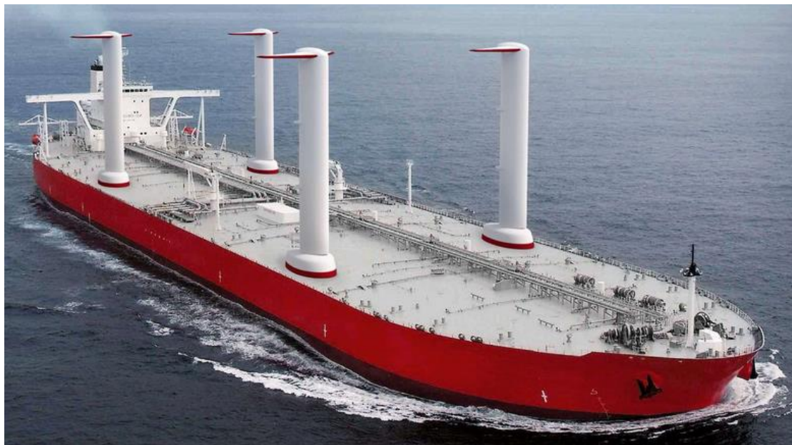
Εικόνα 3-8: Oil tanker, τύπου VLCC με ιστία - πτέρυγες αναρρόφησης (Πηγή Google)
