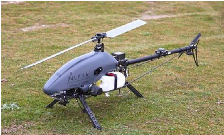
Εικόνα 5.3 UAV μονού ρότορα (Πηγή : Sky-Farmers: Applications of Unmanned Aerial Vehicles (UAV) in Agriculture | IntechOpen)
