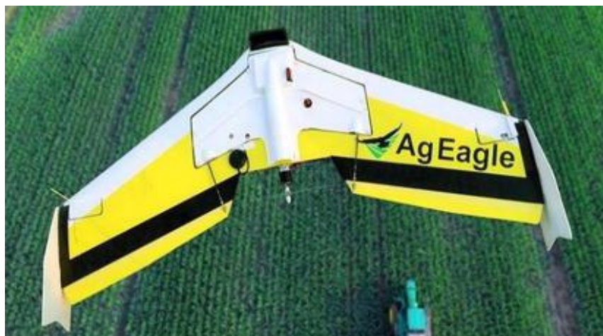
Εικόνα 5.2. UAV σταθερής πτέρυγας
