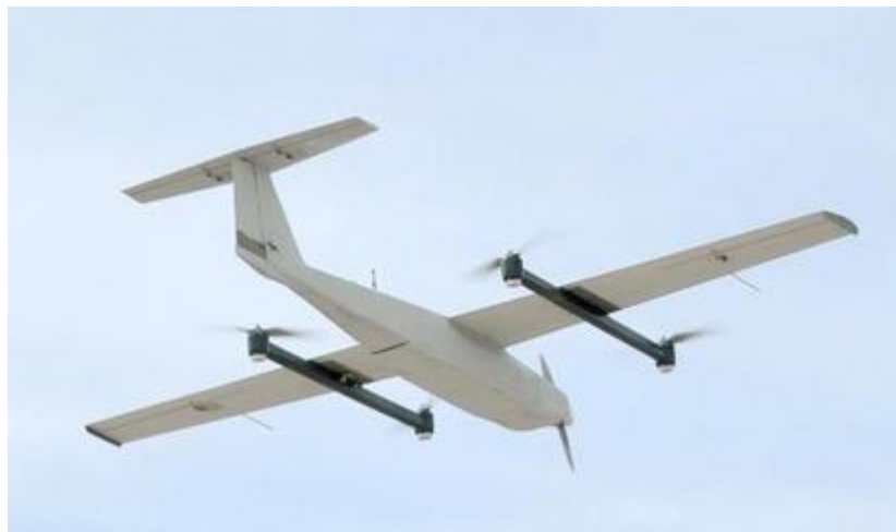
Εικόνα 5.4 Υβριδικό UAV με σταθερά φτερά και πολλαπλούς ρότορες (Πηγή : Sky-Farmers: Applications of Unmanned Aerial Vehicles (UAV) in Agriculture | IntechOpen)
