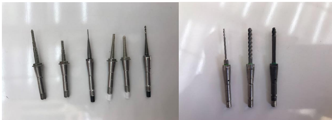
Εικ. 17 & 18: Παραδείγματα φρεζών που χρησιμοποιούν τα κοπτικά μηχανήματα. Ποικίλλουν μορφολογικά ανάλογα το περιστατικό
