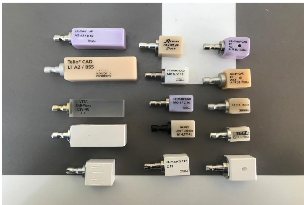
Εικ. 33 : Μπλοκ υλικών. Τα λευκά μπλοκ είναι ζirkονίου, τα μωβ μπλοκ είναι διπυριτικού λιθίου, τα μπεζ μπλόκ είναι ακρυλικά, υβριδικά κεραμικά και
