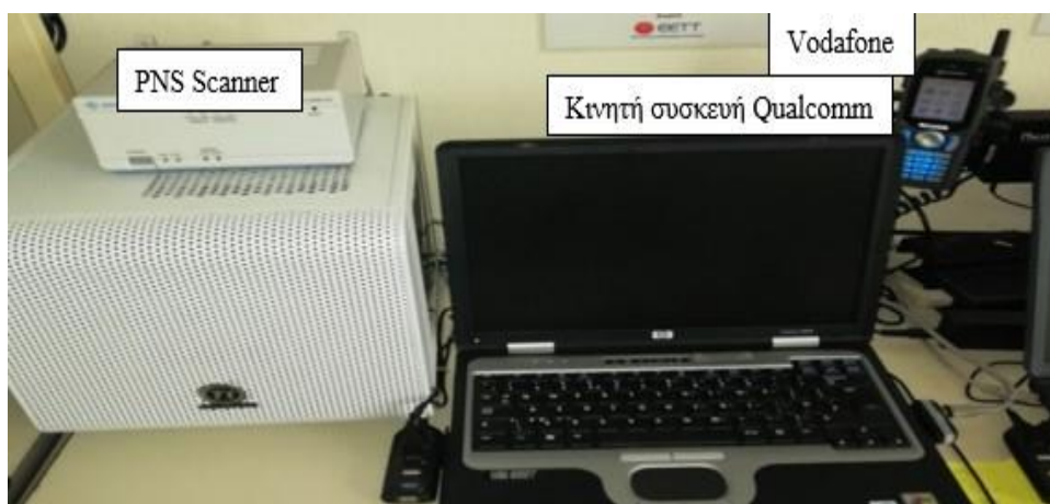
Εικόνα 3.34 UMTS Μετρητική Διάταξη – Εξοπλισμός
