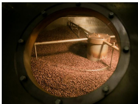
Εικόνα 12: Περιστρεφόμενος κύλινδρος καβουρδίσματος Πηγή: https://www.deahellas.gr/image/cache/data/1_cover-800x600.jpg
