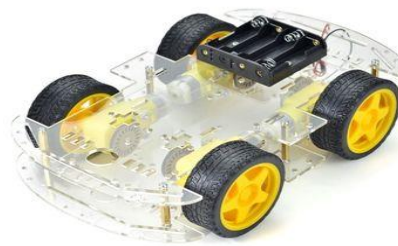
Εικόνα 20: Σασί αυτοκινήτου μαζί με τους κινητήρες και τη θήκη μπαταριών[14].
