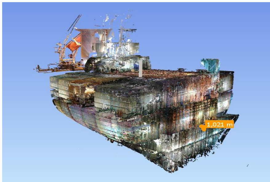
Εικόνα 22: Απεικόνιση μέρους του πλοίου από την φρακτή του μηχανοστασίου έως την πρύμνη του. Το τελικό νέφος αποτελείται από 75 διαδοχικές σαρώσεις.
