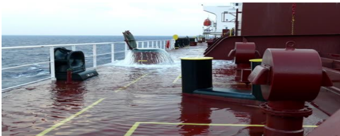
Εικόνα 9: Η μέθοδος υπεργείλισης έρματος
