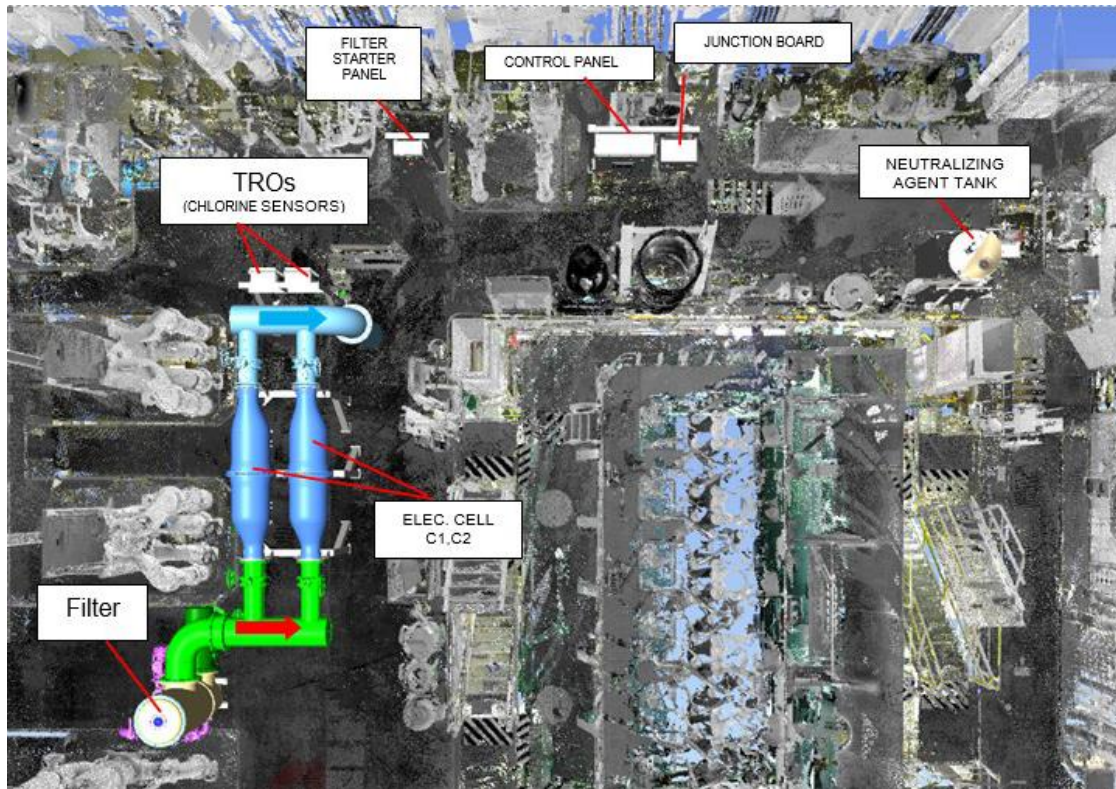
Εικόνα 50: Κυρίως σύστημα και ηλεκτρολογικός εξοπλισμός του BWTS (κάτοψη). Τα κόκκινα βέλη συμβολίζουν τη ροή προς την είσοδο του συστήματος ενώ τα μπλε, την ροή της εξόδου από το σύστημα προς τις δεξαμενές έρματος.
