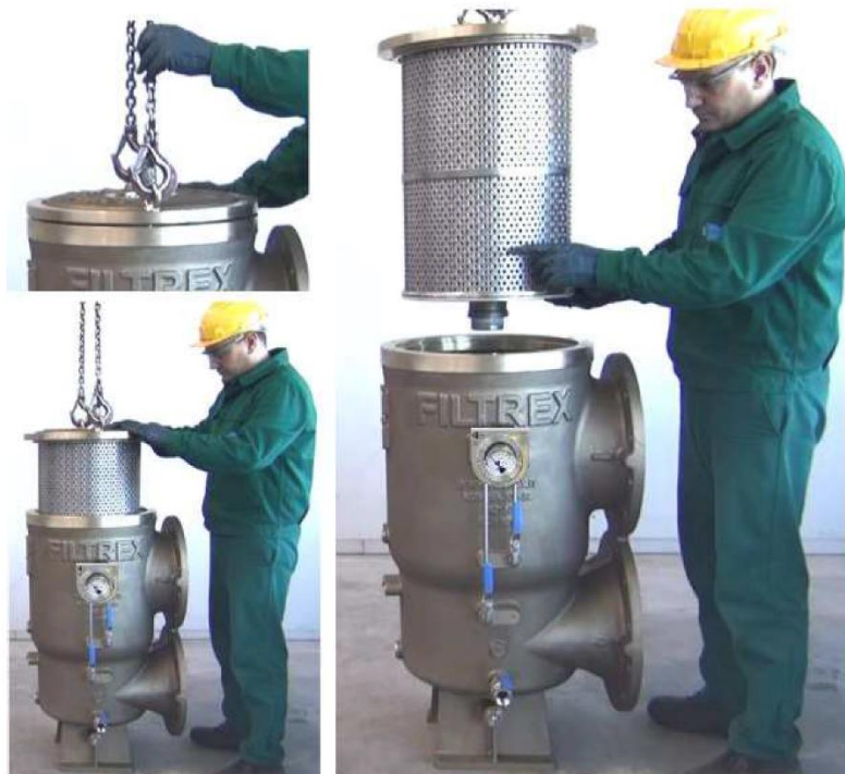
Εικόνα37: Κατά το σχεδιασμό του συστήματος πρέπει να ληφθεί υπόψιν ο απαραίτητος χώρος και τα μέσα για τη συντήρηση του φίλτρου
