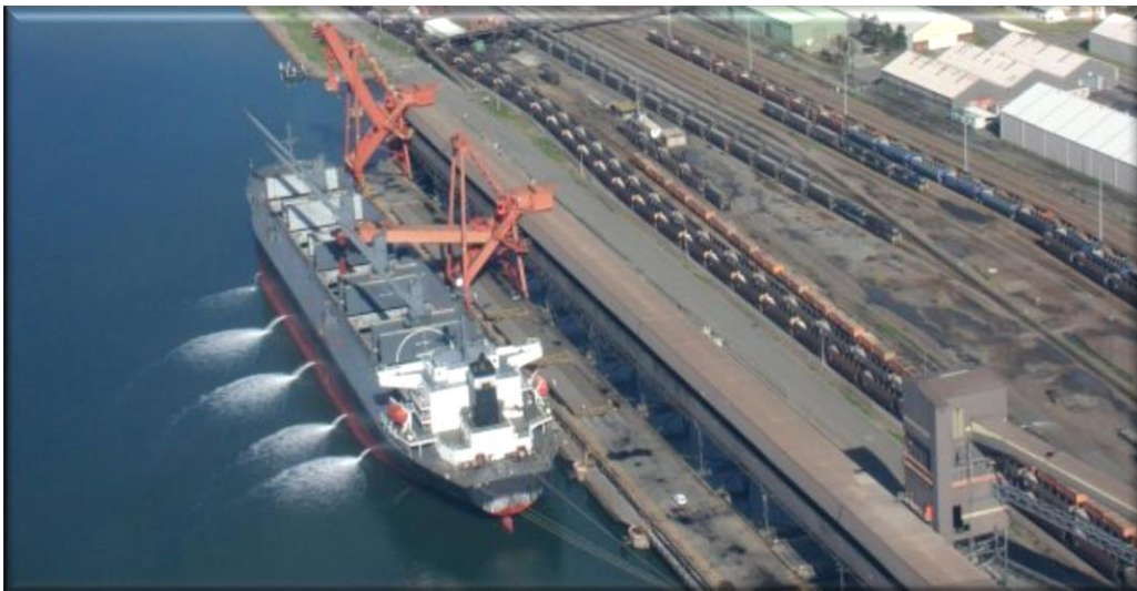
Εικόνα 25: Η εγκατάσταση ενός αξιόπιστου συστήματος επεξεργασίας έρματος για τα φορτηγά πλοία, Ιαπωνικής συνήθως κατασκευής, που διαθέτουν by gravity discharge Top Side Tanks , αποτελεί μεγάλη πρόκληση.
