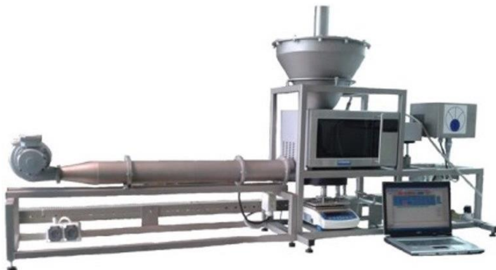
Εικόνα 3. Υβριδικός ξηραντήρας εξοπλισμένος με αερομεταφερόμενο σύστημα υπερήχων (Airborne Ultrasonic System). Πηγή: https://www.pusonics.es/dehydration-assisted-by-ultrasound
