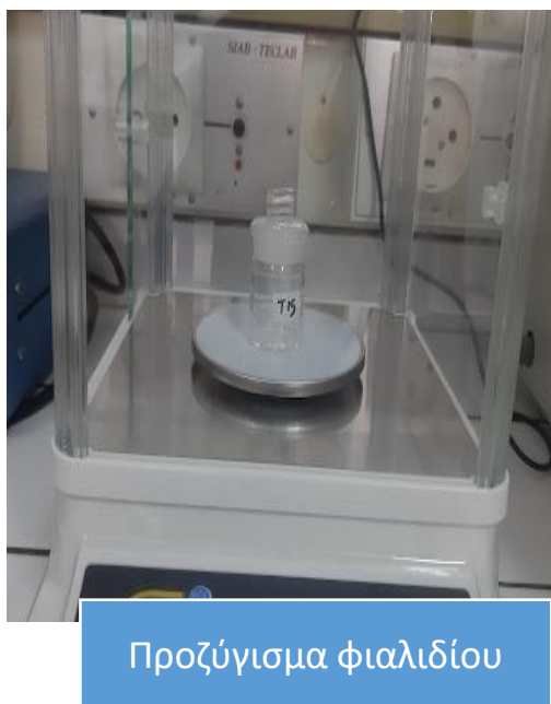
Εικόνα 5.10 : Αριστερά προζύγισμα φιαλιδίου, δεξιά ζύγισμα φιαλιδίου και δείγματος μανιταριού στον αναλυτικό ζυγό του εργαστηρίου
