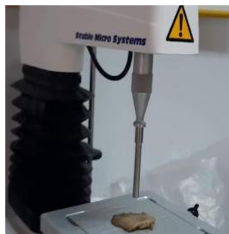
Αναλυτής υφής εργαστηρίου (κατά τη διάρκεια ανάλυσης υφής μανιταριού)
