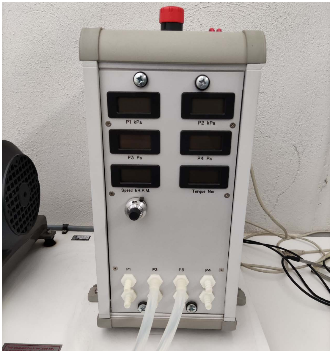
Εικόνα 3.10: Κεντρική μονάδα ελέγχου. Διακρίνονται οι ενδείξεις πίεσης, η ροπή στρέψης, η ταχύτητα περιστροφής και ο ρυθμιστής της και οι υποδοχές για τη καταγραφή της πίεσης
