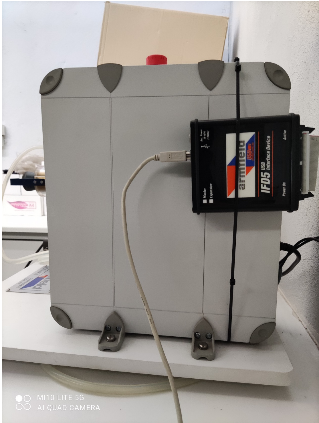
Εικόνα 3.3: Δεξιά πλάγια όψη όπου διακρίνεται και το καταγραφικό (data logger)
