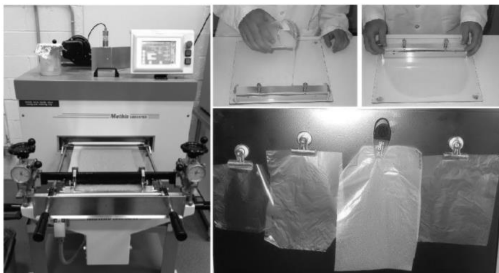
Εικόνα 13: Μια απλή εργαστηριακή διαδικασία για την κατασκευή ταινιών κόμμεος, με χρήση εργαστηριακής επίστρωσης (αριστερά) ή χειροκίνητα (δεξιά.). Και οι δύο δείχνουν ένα μαχαίρι χύτευσης να απλώνει ένα λεπτό στρώμα διαλύματος κόμμεος σε ανοξειδωτή ή γυάλινη πλάκα. Η διαδικασία στα αριστερά περιλαμβάνει την ξήρανση της πλάκας με επικάλυψη κόμμεος μέσα στο μηχάνημα, και η διαδικασία στα δεξιά περιλαμβάνει ξήρανση στον αέρα είτε σε φούρνο είτε στον αέρα περιβάλλοντος, και στη συνέχεια το φιλμ αποκολλάται με το χέρι.
