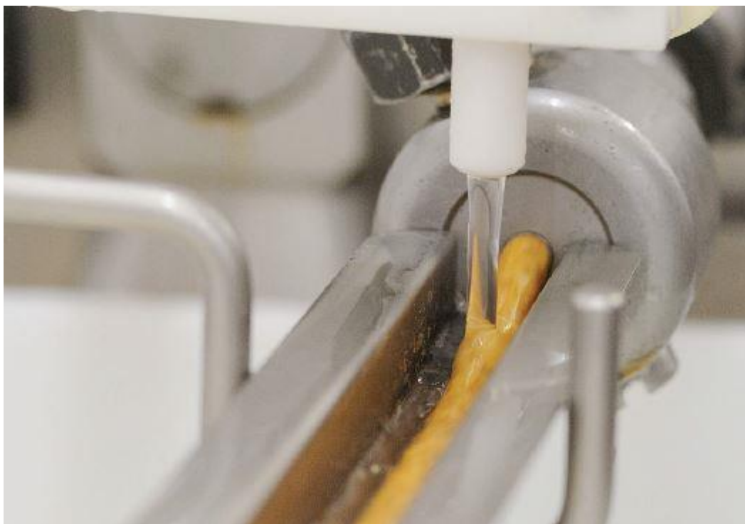
Εικόνα 14: Το εξωθημένο λουκάνικο βρέχεται με διάλυμα χλωριούχου ασβεστίου
