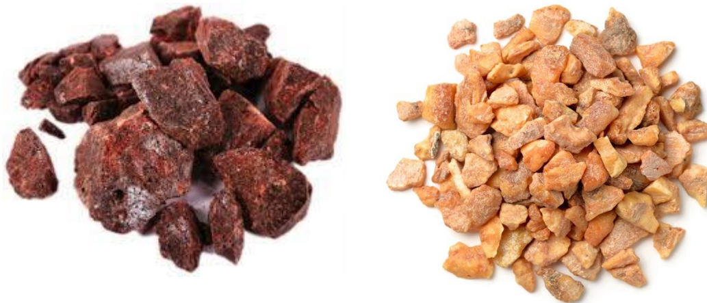
Εικόνα 18: Dragon blood σκληρή ρητίνη (αριστερά) και Styrex μαλακή ρητίνη (δεξιά)
