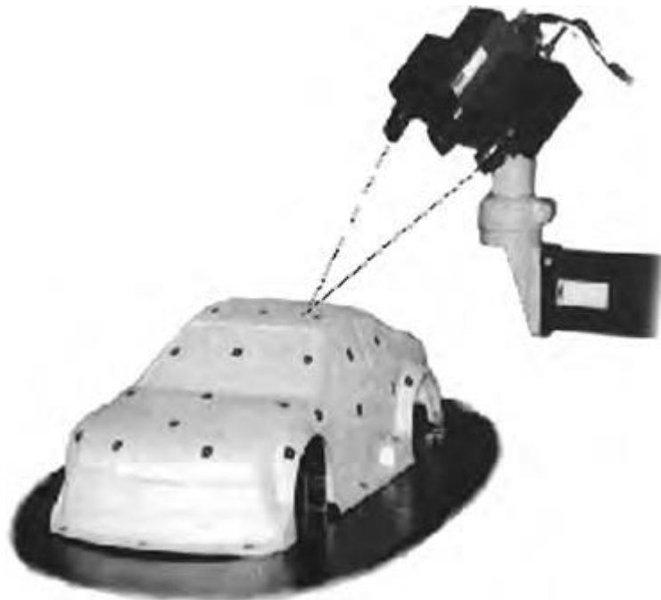
Εικόνα 19. Οπτικό σύστημα σάρωσης (Πηγή: Reverse Engineering: An Industrial Perspective)
