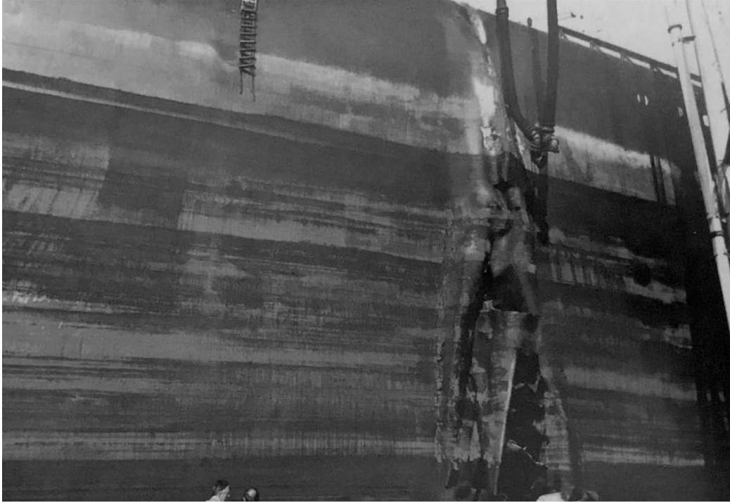
Εικόνα 42: Λυγισμός και σχάση του ελάσματος της πλευρικής κατασκευής. (Πέτρος Α. Καρύδης. Επιθεώρηση, Συντήρηση και Επισκευή της Μεταλλικής Κατασκευής του Πλοίου . Πανεπιστημιακές Εκδόσεις Ε.Μ.Π., 2002.)
