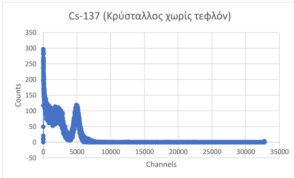
Σχήμα 4. 17: Φάσμα 137 Cs με κρύσταλλο διαστάσεων 3×3×8 mm 3 χωρίς τεφλόν.
