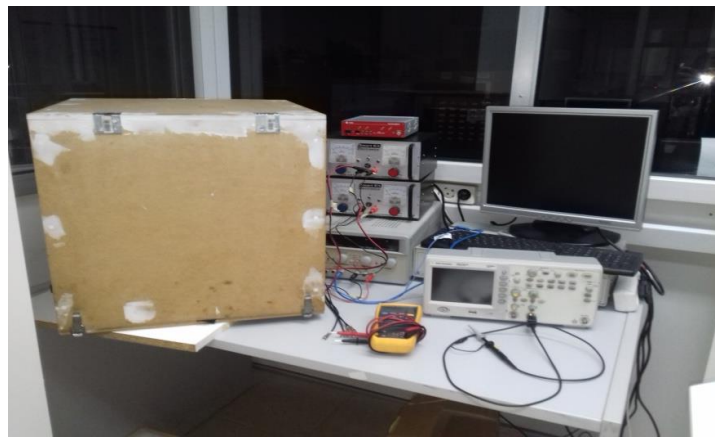
Σχήμα 3.18: Πειραματική διάταξη. Διακρίνονται το φωτοστεγανό κουτί, ο ψηφιοποιητής καθώς και οι πηγές τάσης του προενισχυτή και του SiPM. Διακρίνονται επίσης ένας παλμογράφος και ένα πολύμετρο.
