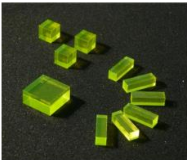
Σχήμα 3.14: Κρυσταλλικοί σπινθηριστές GAGG:Ce.
