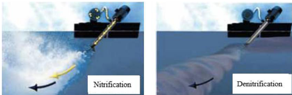
Εικόνα 3.5: Αερισμός και ανάμειξη (αριστερά) και ανάμειξη (δεξιά) με το σύστημα Aire O 2 Triton Πηγή: Singrova & Sevcik, 2020
