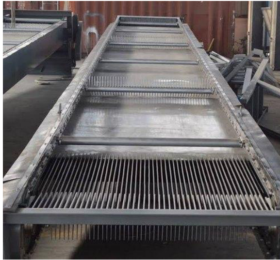
Εικόνα 1.2: Σχάρα για διαχωρισμό στερεών- υγρών αποβλήτων, κατάλληλη για εσωτερικούς και εξωτερικούς χώρους, όπως και για βαθιά κανάλια
