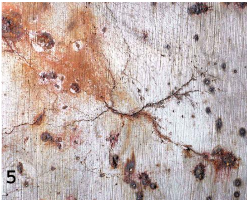
Εικόνα 3. Αποτέλεσμα μηχανικής διάβρωσης ( Stress Corrosion Cracking ) (πηγή: http://www.metalconsult.com/stress-corrosion-cracking-reactor-vessel.html ).
