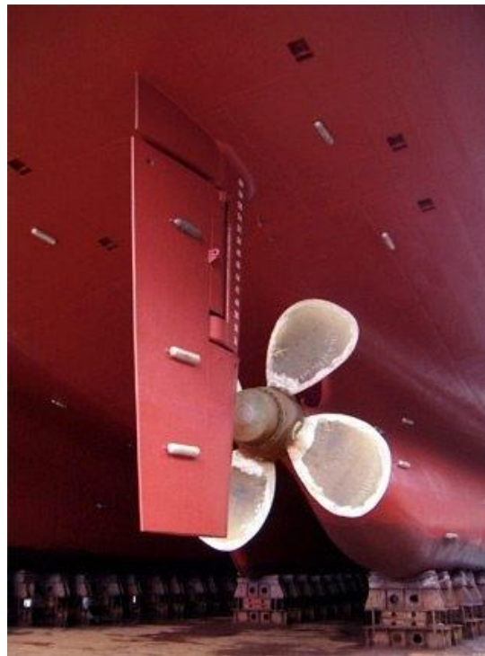
Εικόνα 8. Θυσιαζόμενα ανόδια τοποθετημένα στην γάστρα και στο πηδάλιο πλοίου (πηγή: https://el.wiktionary.org/wiki/%CF%80%CE%B7%CE%B4%CE%AC%CE%BB%CE%B9%CE%BF ).
