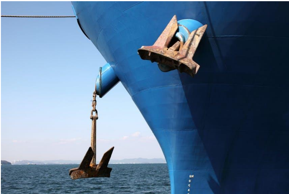
Εικόνα 14. Άγκυρα πλοίου με σημάδια διάβρωσης τόσο στην αλυσίδα όσο και στο κύριο σώμα αυτής (Alandia 2020).
