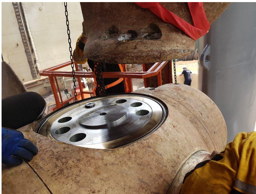
Εικόνα 22. Αντικατάσταση των O-rings των πτερυγίων έλικας (πηγή: https://mpss.gr/el/projects/controllable-pitch-propeller-o-rings-replacement/ ).
