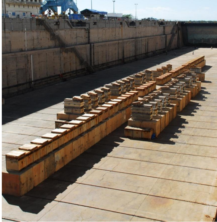
Εικόνα 19. Στηρίγματα πλοίου σε δεξαμενισμό (Nakahara 2010).
