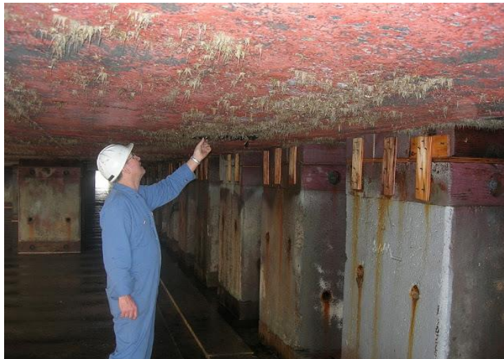
Εικόνα 20. Έλεγχος πυθμένα πάνω σε στηρίγματα κατά το δεξαμενισμό πλοίου (Mayor 2013b).
