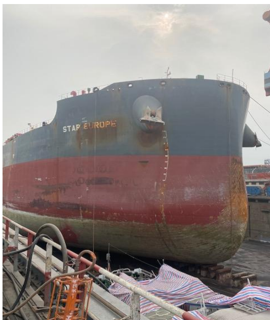
Εικόνα 24. Το πλοίο κατά τον δεξαμενισμό του. Φαίνονται οι φθορές από τη διάβρωση της γάστρας (πηγή: Chartworld Shipping Corp. 2020).
