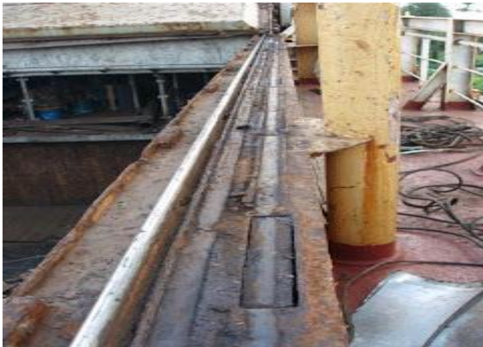
Εικόνα 10. Οδηγός πάνω στους οποίους εδράζονται τα καλύμματα των δεξαμενών εμφανίζονται να έχουν διαβρωθεί (Μαγιορ 2013α).
