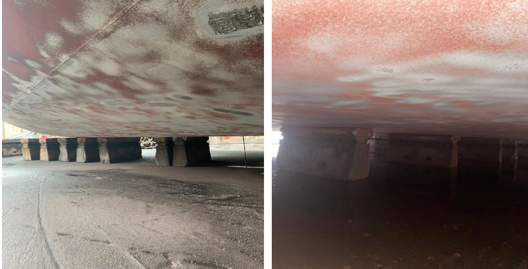
Εικόνα 29. Τμήμα της γάστρας του πλοίου μετά τον καθαρισμό βαθμού Sa1 με αμμοβολή (πηγή: Chartworld Shipping Corp. 2020).
