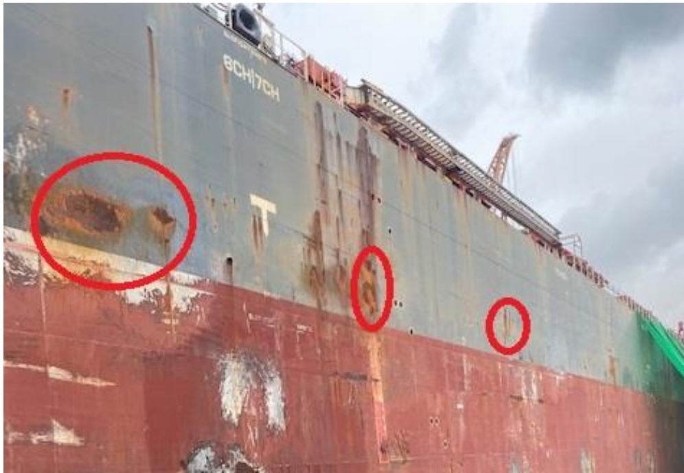
Εικόνα 26. Έντονη τοπική διάβρωση στην εξωτερική επιφάνεια της γάστρας, που αφαιρέθηκε με καλέμι κατά τη διάρκεια εργασιών συντήρησης του πλοίου (πηγή: Chartworld Shipping Corp. 2020).
