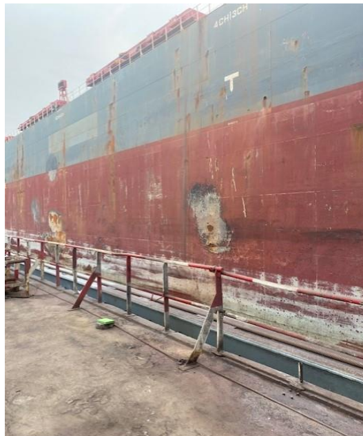
Εικόνα 24. Το πλοίο κατά τον δεξαμενισμό του. Φαίνονται οι φθορές από τη διάβρωση της γάστρας (πηγή: Chartworld Shipping Corp. 2020).
