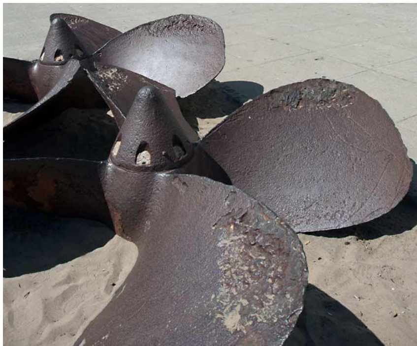
Εικόνα 5. Σπηλαιώδης διάβρωση σε έλικα πλοίου (πηγή: PES solutions 2014).
