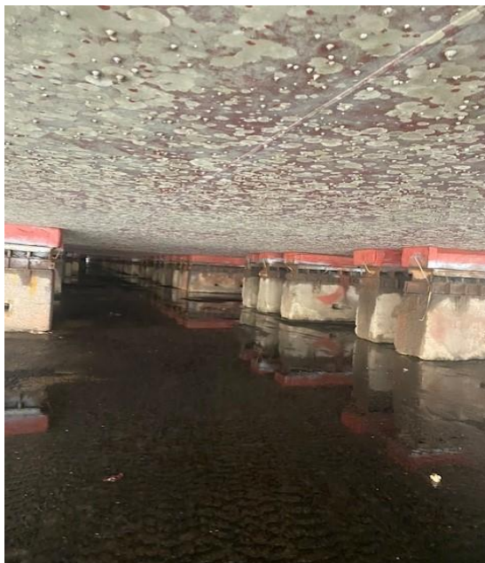
Εικόνα 25. Βιορύπανση στη γάστρα του πλοίου (πηγή: Chartworld Shipping Corp. 2020).
