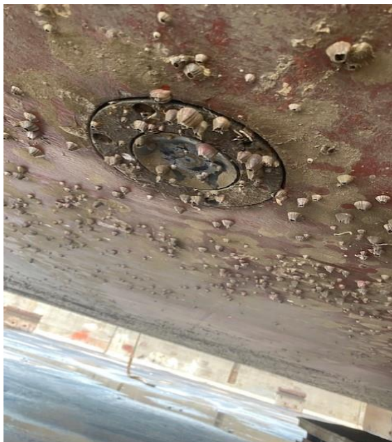
Εικόνα 25. Βιορύπανση στη γάστρα του πλοίου (πηγή: Chartworld Shipping Corp. 2020).
