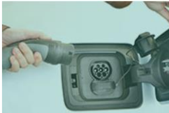
Εικόνα 2.20 Υποδοχή βύσματος Τύπου 2 / IEC 62196
