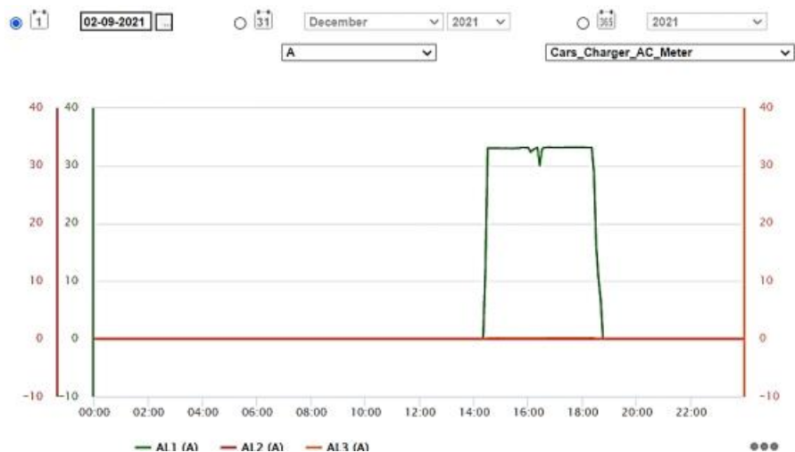
Σχήμα 2.3 Διάγραμμα έντασης ρεύματος (A) – Χρόνου (t) από το Carlo Gavazzi για την ημιταχεία φόρτιση του ηλεκτρικού λεωφορείου στις 02/09/2021
