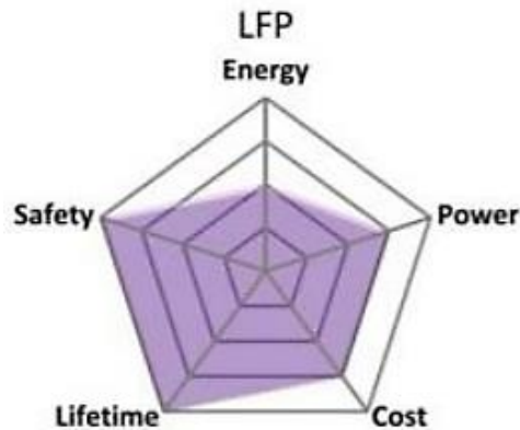
Εικόνα 2.7 Διάγραμμα παραμέτρων απόδοσης μπαταρίας LFP
