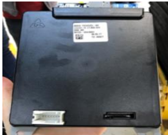
Εικόνα 2.17 Ενσωματωμένο Σύστημα Διαχείρισης Μπαταρίας (BMS) ηλεκτρικού λεωφορείου
