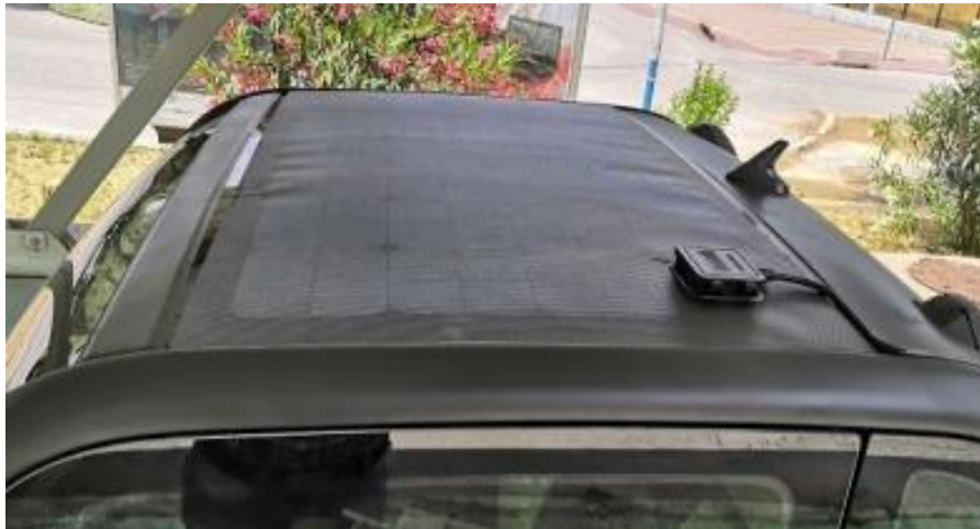
Εικόνα 2.3 Φωτοβολταϊκός συλλέκτης οροφής ηλεκτρικού οχήματος
