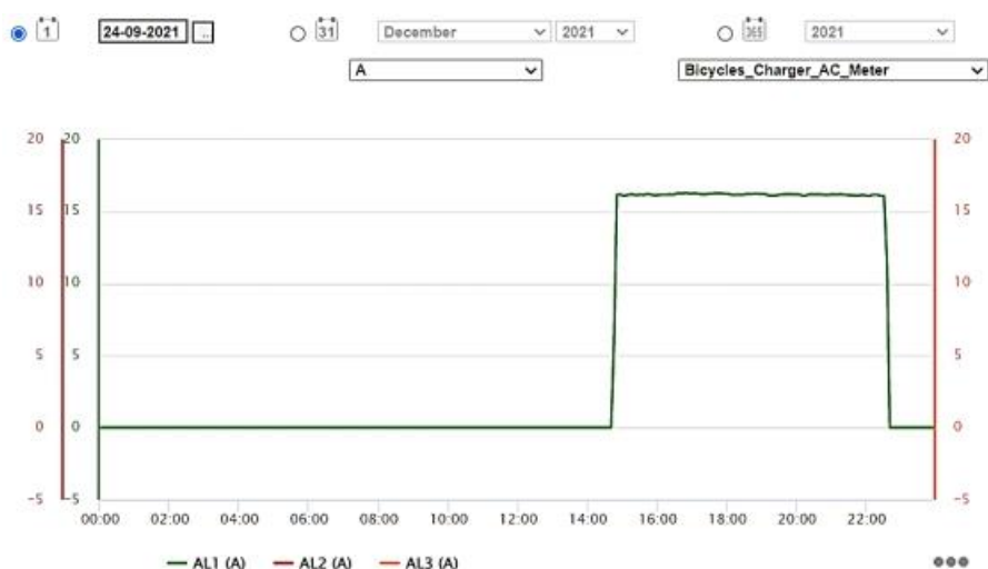
Σχήμα 2.2 Διάγραμμα έντασης ρεύματος (A) – Χρόνου (t) από το Carlo Gavazzi για την αργή φόρτιση του ηλεκτρικού λεωφορείου στις 24/09/2021
