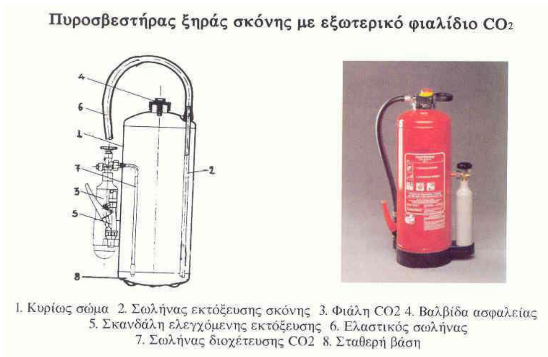
Εικόνα 4 : Πυροσβεστήρας ξηράς σκόνης με CO 2
