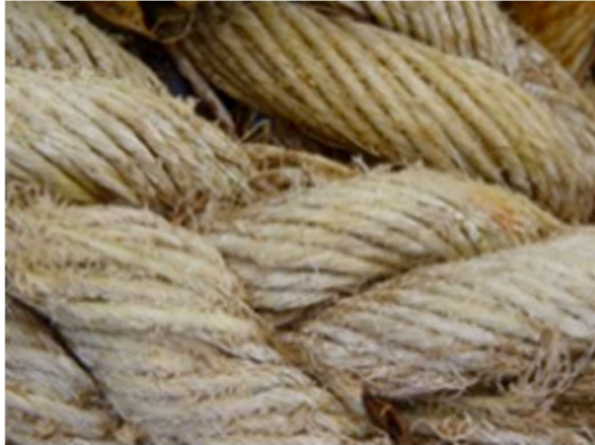
Εικόνα 30: Σχοινί αγκύρωσης κατασκευασμένο από Sisal (και άλλα συνθετικά υλικά) [πηγή: https://www.elmsmoorings.co.uk/different-types-of-mooring-lines/ ]
