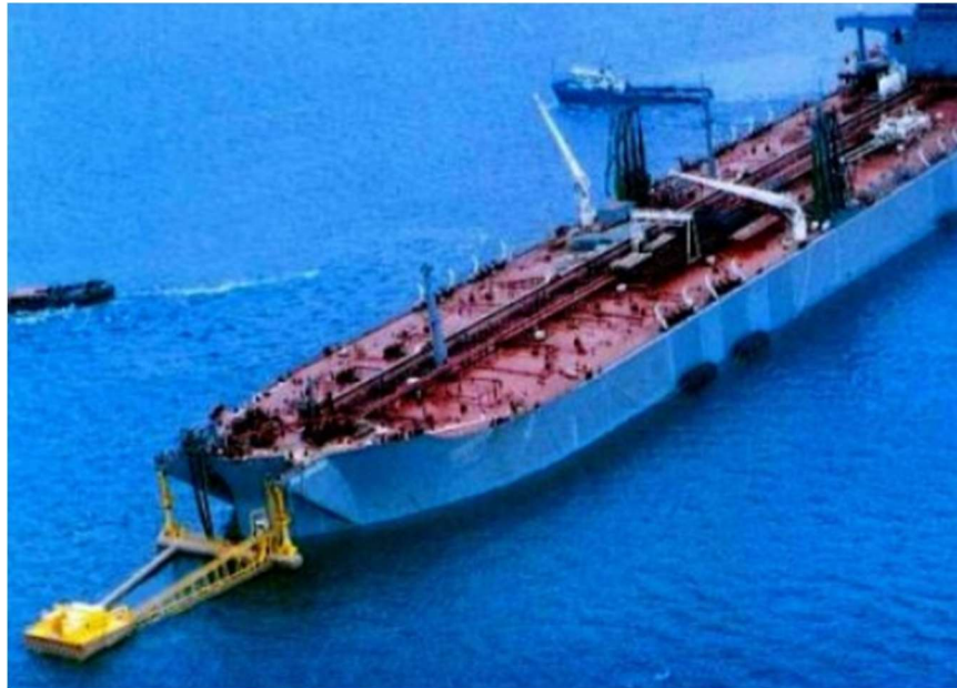
Εικόνα 19: Σύστημα Αγκύρωσης soft yoke στη Νιγηρία [πηγή: https://www.bluewater.com/products-technology/mooring-systems/spread-mooring/soft-yoke-spm-buoy-system/ ]
