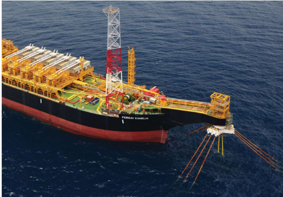
Εικόνα 20: Σύστημα Αγκύρωσης με εξωτερικό πυργίσκο [πηγή: https://www.londonmarine.co.uk/mooring-systems/external-cantilever-turret/ ]
