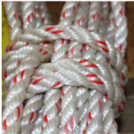
Εικόνα 29: Σχοινί αγκύρωσης κατασκευασμένο από νάιλον [πηγή: https://www.elmsmoorings.co.uk/different-types-of-mooring-lines/ ]
