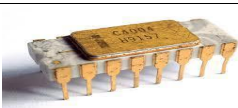
Εικόνα 15: Πρώτος μικροεπεξεργαστής Πηγή: https://en.wikipedia.org/wiki/Intel_4004
