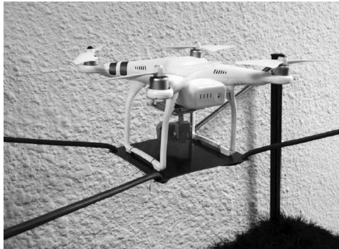
Εικόνα 33: Το MEEO DJI Phantom 3 Standard πάνω στην εύκαμπτη βάση [15]
