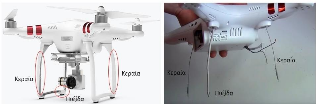
Εικόνα 80: Κεραίες και πυξίδα του drone DJI Phantom 3 Standard [54]
