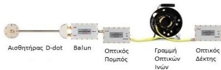
Εικόνα 54: Σύνδεση του αισθητήρα Montena SFE3-5G με το balun και τη γραμμή οπτικών ινών [47]
