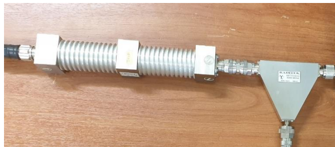
Εικόνα 46: Φίλτρο και κυκλοφορητής
