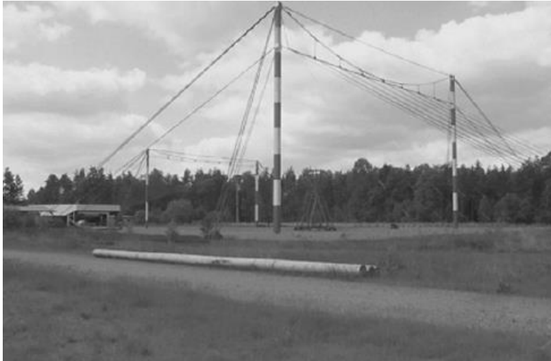
Εικόνα 1: TEM κυματοδηγός εξωτερικού χώρου (WIS, Munster, Germany) [9]
