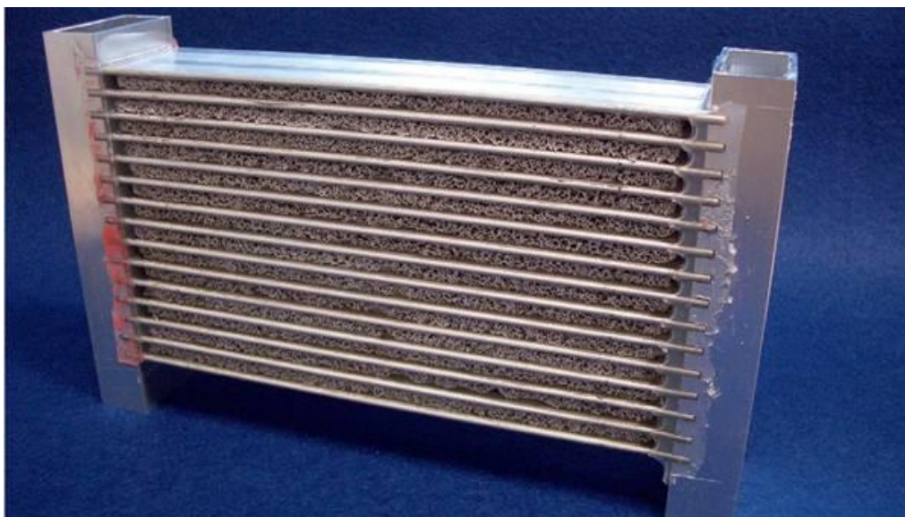
Εικόνα 4.6: Χρήση μεταλλικών αφρών σε εναλλάκτες θερμότητας (πηγή: https://www.filter-elements.org/filter-elements/metallic-foams.html )
