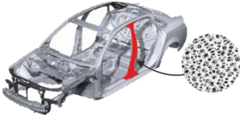
Εικόνα 4.4: Μεταλλικοί αφροί στην αυτοκινητοβιομηχανία (πηγή: https://technologystudent.com/joints_flash/metalfoam2.html )
