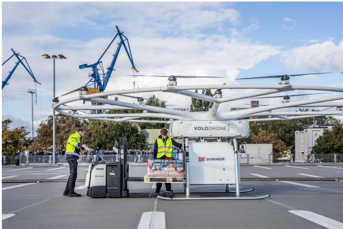
Εικόνα 10: Οι ομάδες επίδειξης εξασφαλίζουν ένα φορτίο μεγέθους ευρωπαϊλέτας στο κουτί κάτω από το VoloDrone
