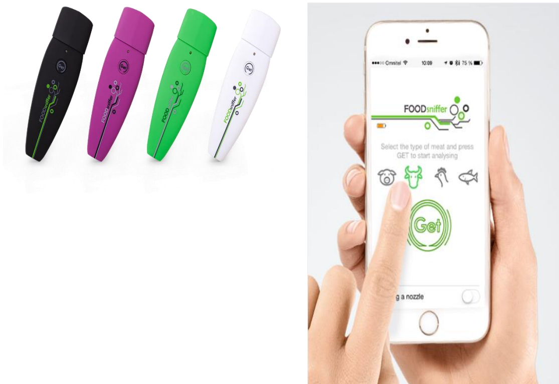
Εικόνα 41: FOODsniffer και εφαρμογή FOODsniffer που εκτελεί μια βιο-οργανική δοκιμή που μπορεί να "μυρίσει" και να ελέγξει εάν το κρέας είναι καλό για κατανάλωση.( http://www.myfoodsniiffer.com )
