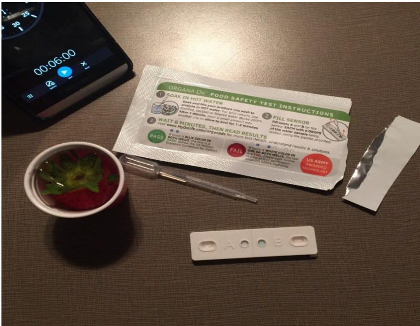
Εικόνα 39: Αισθητήρας μια χρήσης της OrganaDx™ - Πηγή: ( https://www.mydxlife.com/organa-sensor-v2 )
