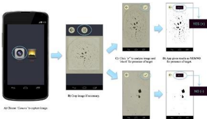
Εικόνα 16: Ανίχνευση Salmonella spp. χρησιμοποιώντας τροποποιημένη εφαρμογή Android: (Α) Επιλέγεται η ρύθμιση της κάμερας για τη λήψη εικόνας, (Β) περικοπή της εικόνα εάν χρειάζεται, (C) Η εικόνα αναλύεται χρησιμοποιώντας έναν προσαρμοσμένο αλγόριθμο για τον υπολογισμό της «Ποσοστό συγκέντρωσης», (D) Τα αποτελέσματα δίνονται ως μια απλή έξοδος ΝΑΙ/ΟΧΙ για ευκολία στην ερμηνεία – Πηγή: DuVall et al., 2015
