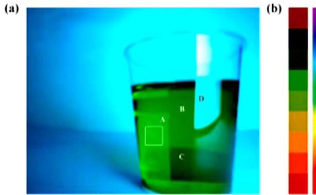
Εικόνα 32: Το 50ο καρέ ενός βίντεο smartphone. Το δείγμα λαδιού φωτίστηκε χρησιμοποιώντας οθόνη smartphone (κυανό χρώμα) και το επιλεγμένο ROI με 70 \times 70 pixel σημειώθηκε σε λευκό τετράγωνο, (β) ένα υποσύνολο εικόνων απόδοσης επένδυσης (ROI) και μια ακολουθία χρωμάτων που ποικίλλει από μωβ έως κόκκινο – Πηγή: WeiranSong et al., 2020.
