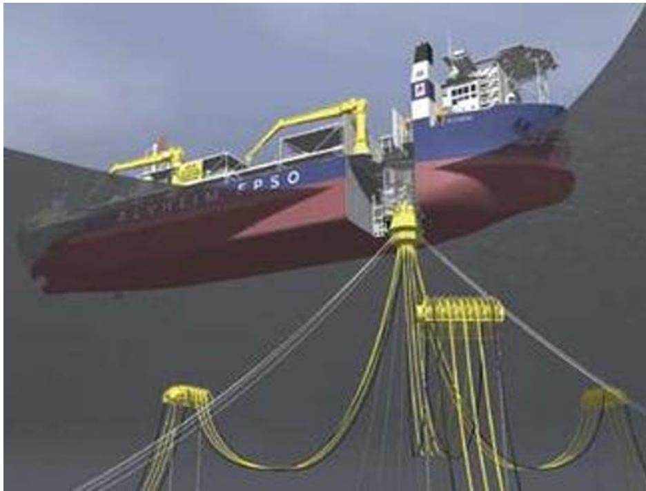
Σχήμα 4-1 Αγκύρωση με πυργίσκο: εδώ φαίνεται μια πλωτή κατασκευή με σύστημα πρόσδεσης με πυργίσκο( https://www.offshore-mag.com/production/article/16762845/apls-technical-scope-tested-by-alvheim-turret-award ).
