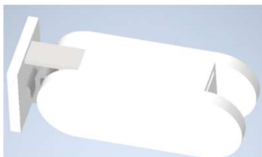
Εικόνα 54 Στιγμιότυπο από συναρμολόγηση εγγύς φάλαγγας, επίπεδης δοκού, βάσης και κυματοειδούς μηχανισμού στο Inventor
