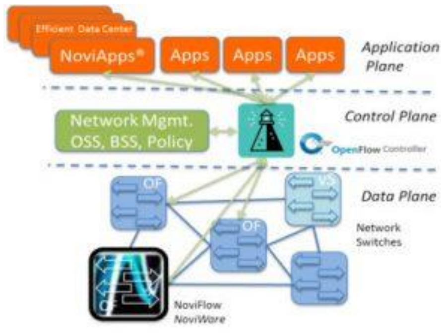
Εικόνα 28: The OpenFlow Architecture (Egilmez et al., 2012)
