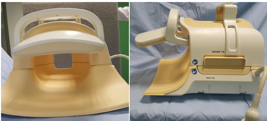
Εικόνα 1.4 : Πηνίο κεφαλής τραχήλου 20 (16+4) καναλιών
