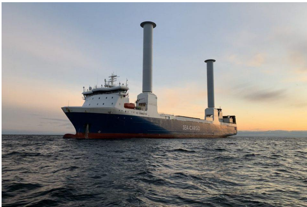
Εικόνα 37: Πλοίο που αξιοποιεί την τεχνολογία “Rotor Sails” (πηγή: Mariska Buitendijk – SWZ|MARITIME, swzmaritime.nl )
