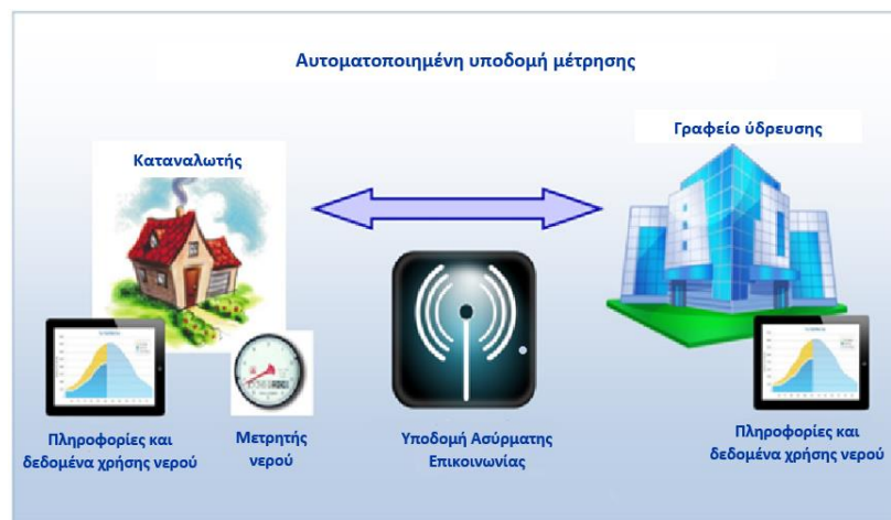
Εικόνα 4.7. Τεχνολογία AMI (Πηγή: Alliance for Water Efficiency, 2014).
