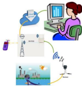
Εικόνα 4.9. Έξυπνο σύστημα παρακολούθησης της ποιότητας των υδάτων (Prasad et al., 2015).
