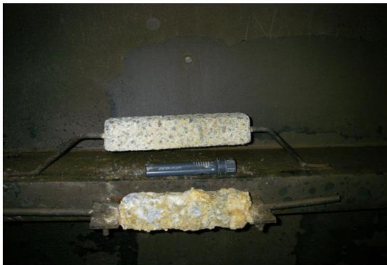
Εικόνα 6. Θυσιάζομενη άνοδος σε δεξαμενή έρματος. Provided by Larus S.A.
