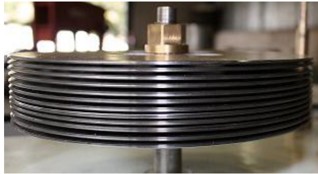
Εικόνα 3: Δίσκοι στερεωμένοι κατά μήκος του άξονα του ρότορα (6) .
