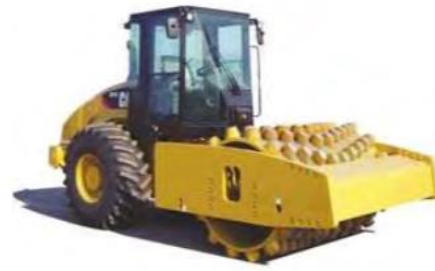
Εικόνα 11: Οδοστρωτήρας δονητικός με λείους κυλίνδρους και τροχούς πίσω και οδοστρωτήρας με κύλινδρο και προεξοχές ( https://dynapac.com/en/products/compaction?tab=products )
