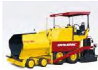
Εικόνα 18:Ερπυστριοφόρος και λαστιχοφόρος διαστρωτήρας ασφάλτου(Finisher)(
