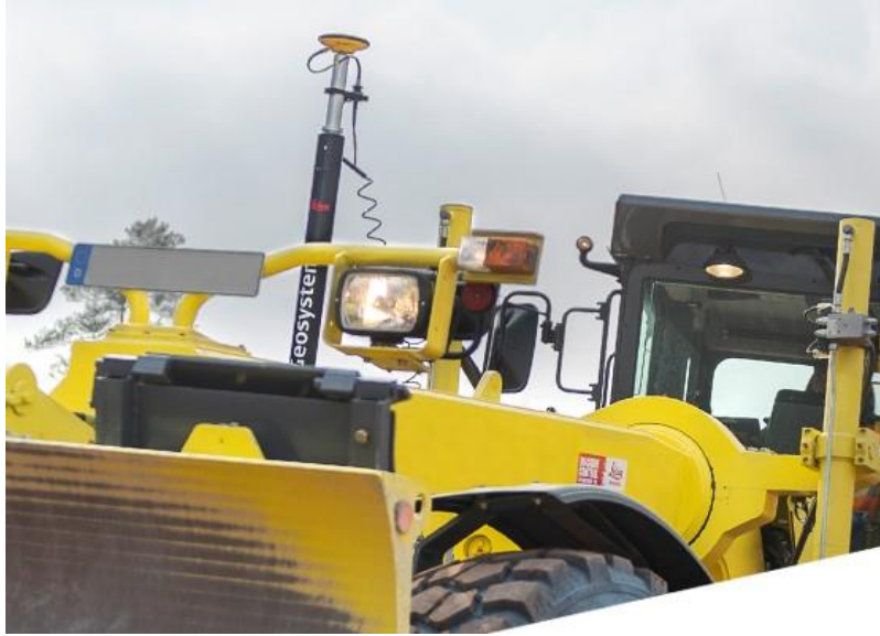
Εικόνα 35:Ιστός εγκατάστασης σε ισοπέδωτή γαιών( https://leica-geosystems.com/products/machine-control-systems )
