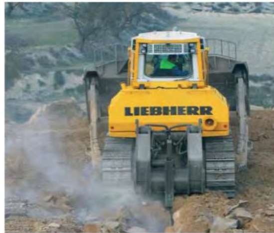
Εικόνα 7:Πρωθητής σε εργασία ώθησης και αναμόχλευσης υλικών ( https://www.bigrentz.com/blog/bulldozer-types )
