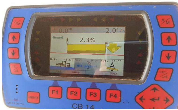
Εικόνα 59:Κεντρική οθόνη 2D συστήματος
