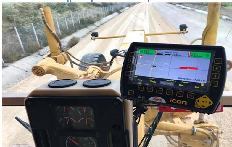
Εικόνα 53:Κεντρική Οθόνη 3D συστήματος
