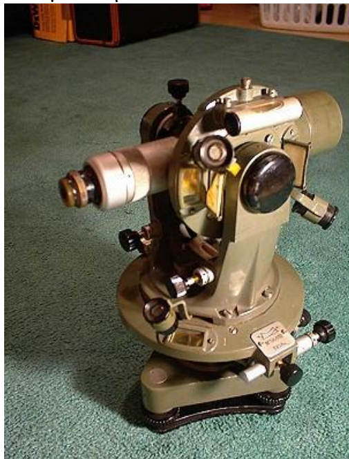
Εικόνα 87:Θεοδολιχος σοβιετικής κατασκευής του 1958
