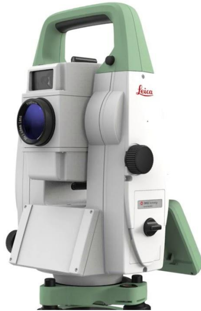
Εικόνα 89: Σύγχρονος Ρομποτικός γεωδαιτικός σταθμός ( https://leica-geosystems.com/products/total-stations/robotic-total-stations )
