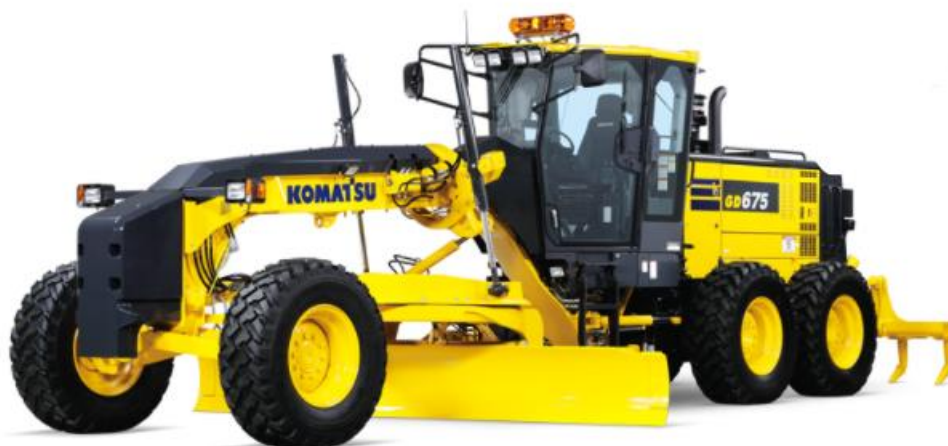
Εικόνα 1:Ισοπεδωτής γαιών ( https://www.komatsu.eu/en/motor-graders/gd675-7 )
