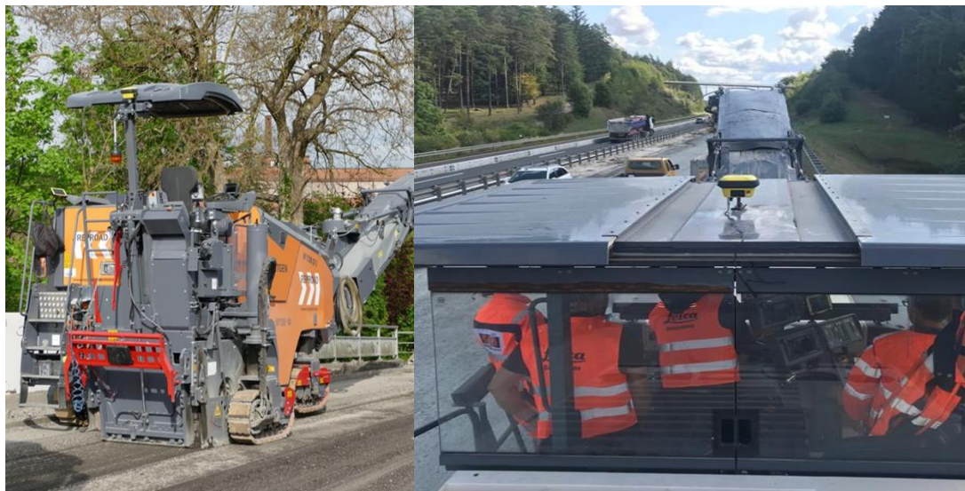
Εικόνα 44:Εγκατεστημένο σύστημα σε φρέζα με χρήση GPS(Leica Geosystems)
