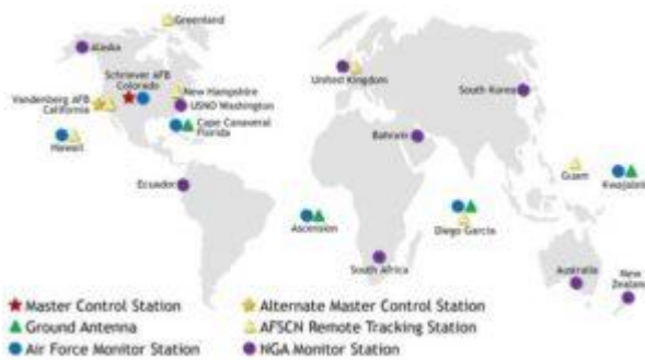
Εικόνα 86:Το δίκτυο επίγειων σταθμών του τμήματος ελέγχου του συστήματος GPS.( http://www.gps.gov/multimedia/images/GPS-control-segment-map.pdf )
