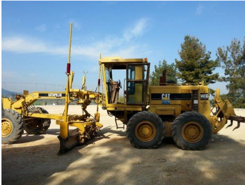
Εικόνα 62:Grader με σύστημα 2D laser
