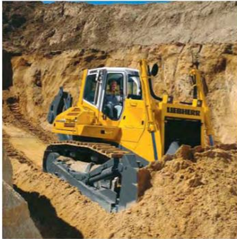
Εικόνα 7:Πρωθητής σε εργασία ώθησης και αναμόχλευσης υλικών ( https://www.bigrentz.com/blog/bulldozer-types )
