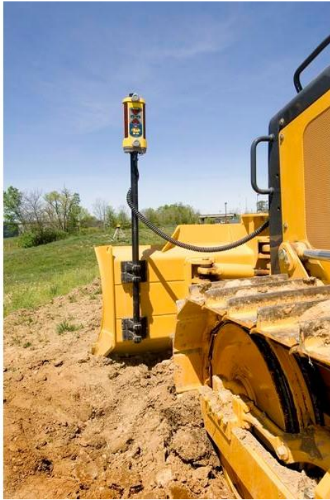
Εικόνα 93: Δέκτης Λείζερ σε Ιστό στήριξης
