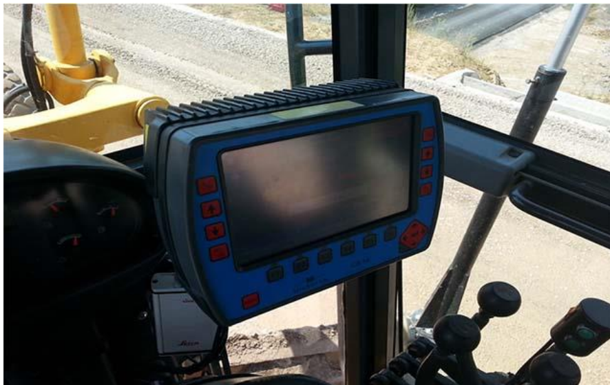
Εικόνα 57:Κεντρική οθόνη 3D συστήματος
