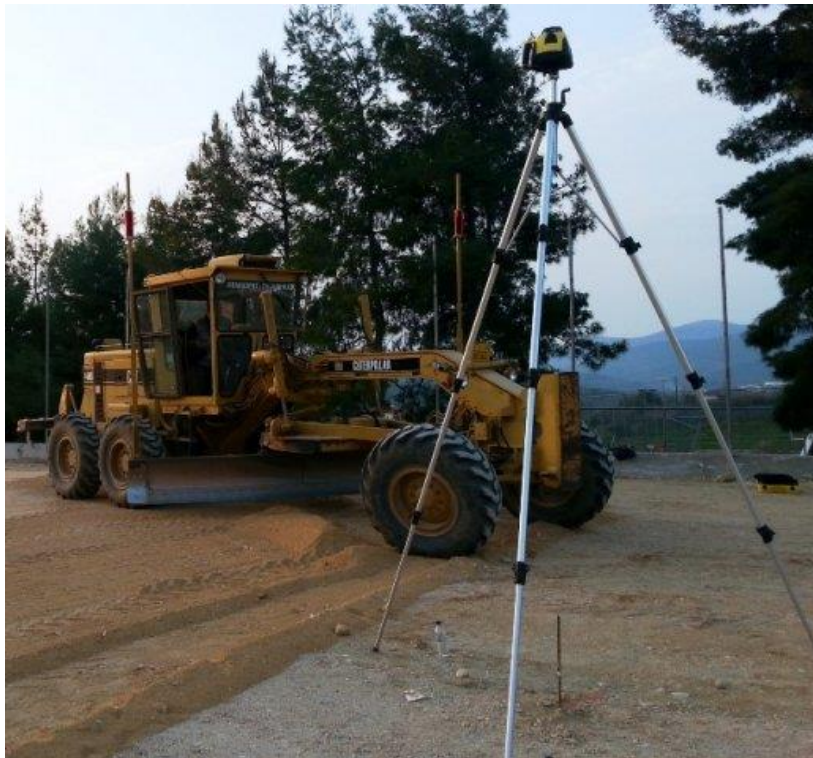
Εικόνα 63:Περιστροφικός χωροβατης Laser
