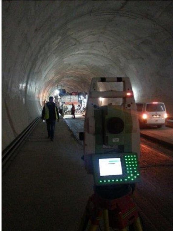
Εικόνα 76:Ρομποτικός σταθμός για 3D σύστημα
