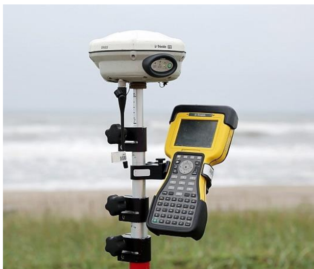
Εικόνα 85:Κεραία GPS μαζί με το χειριστήριο(trimble.com)
