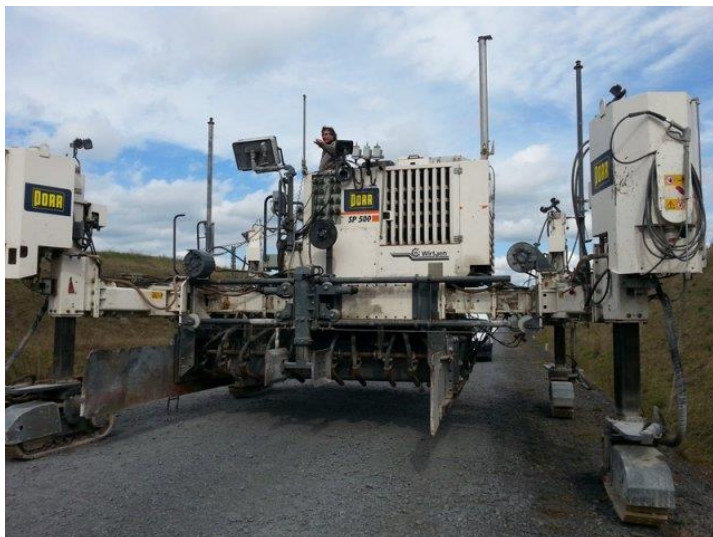
Εικόνα 77: Κρασπεδομηχανή με 3D Σύστημα αυτοματισμού
