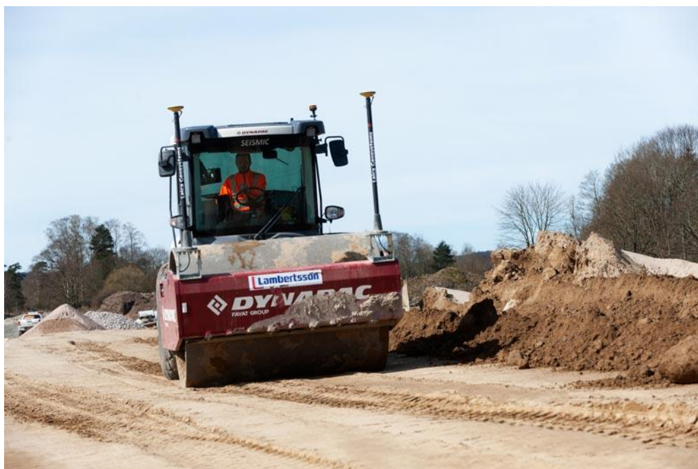
Εικόνα 13: Οδοστρωτήρας με εγκατεστημένο σύστημα συμπίκνωσης ( https://dynapac.com/en/products/compaction?tab=products )
