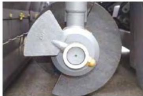
Εικόνα 19:Τροφοδότης υλικού και διανομέας υλικού https://www.theengineeringcommunity.org/asphalt-paver-how-it-works/ )
