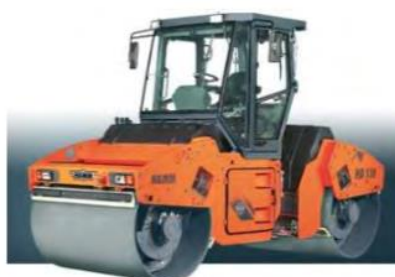
Εικόνα 10: Οδοστρωτήρας στατικός με λείους κυλίνδρους και δονητικός με λείους κυλίνδρους ( https://dynapac.com/en/products/compaction?tab=products )
