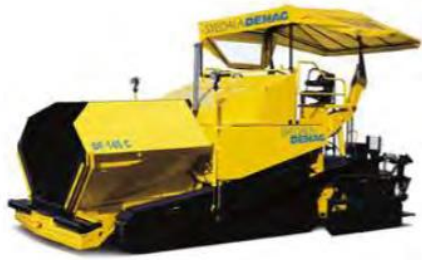
Εικόνα 18:Ερπυστριοφόρος και λαστιχοφόρος διαστρωτήρας ασφάλτου(Finisher)(
