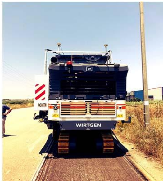
Εικόνα 67: Ιστοί με GPS κεραίες
