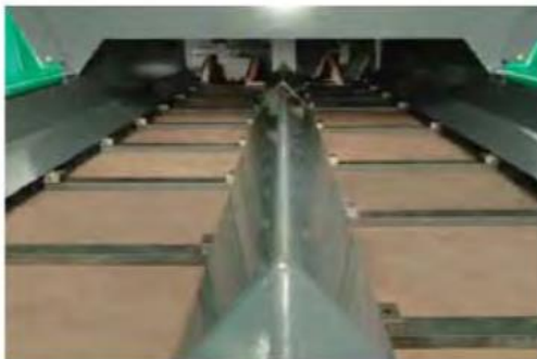
Εικόνα 19:Τροφοδότης υλικού και διανομέας υλικού https://www.theengineeringcommunity.org/asphalt-paver-how-it-works/ )
