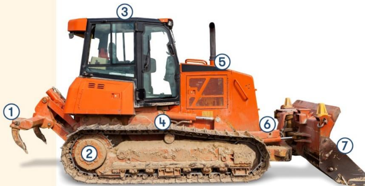
Εικόνα 6: Βασικά μέρη του μηχανήματος ( https://www.bigrentz.com/blog/bulldozer-types )
