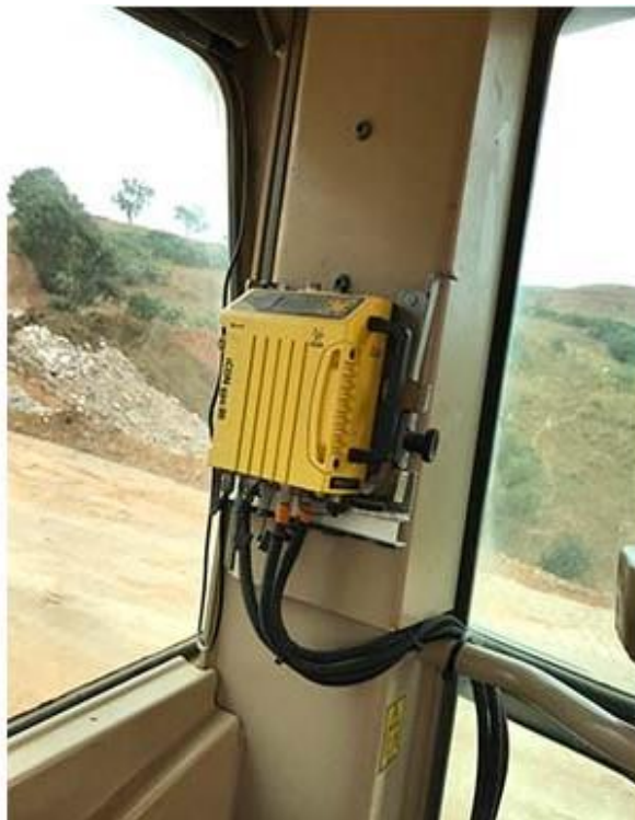
Εικόνα 55: Δέκτης GNSS εντός της καμπίνας του μηχανήματος
