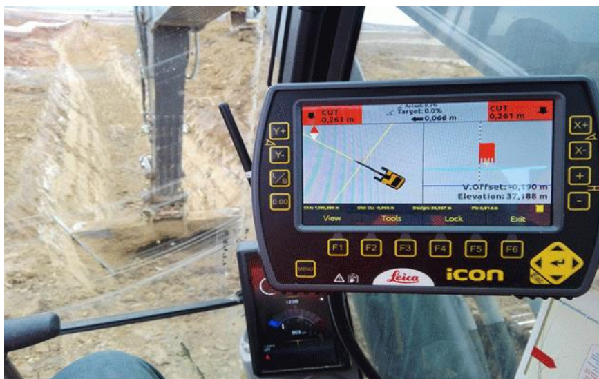
Εικόνα 50:Κεντρική Οθόνη Συστήματος 3D
