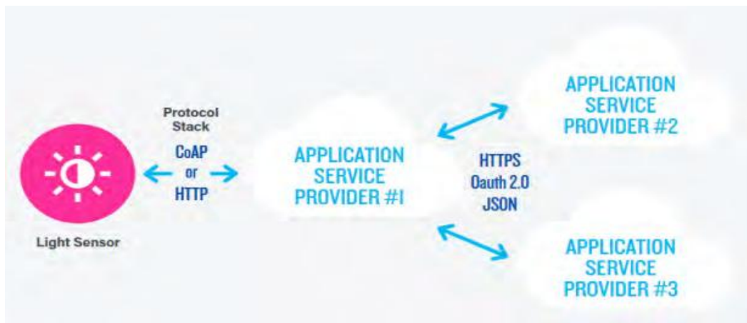
Εικόνα 7: Παράδειγμα Μοντέλου Back-End Data-Sharing [45]
