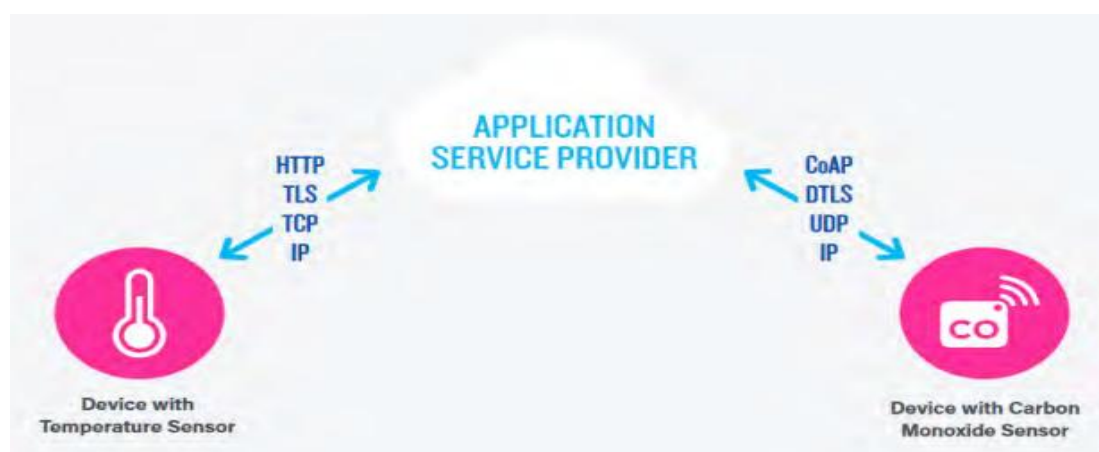
Εικόνα 5: Παράδειγμα Μοντέλου επικοινωνίας Device-To-Cloud [45]
