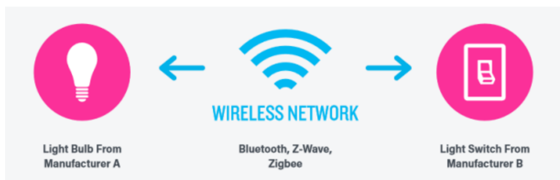
Εικόνα 4: Παράδειγμα Μοντέλου Επικοινωνίας Device-To-Device [45]
