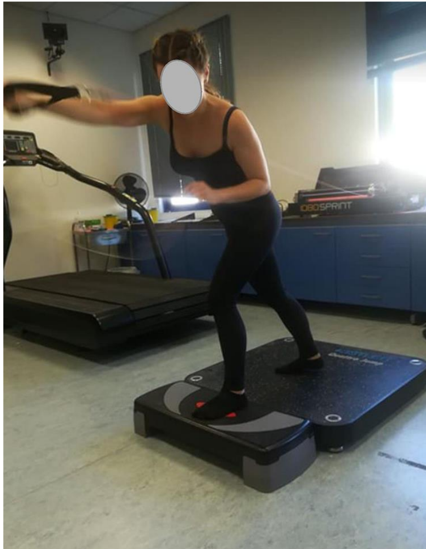
Εικόνα 13. Συνδυασμός μετρήσεων ριπτικής δύναμης και ταχύτητας με το 1080 Sprint και μέτρηση GRF με το δυναμοδάπεδο Kistler.
