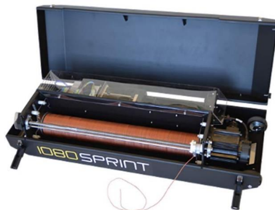
Εικόνα 10. Α) Παρουσίαση δοκιμής ρίψης με την προσομοίωση της κίνησης του καρφιού, με το μηχάνημα μέτρησης ριπτικής δύναμης και ταχύτητας Sprint 1080 Β) Σύστημα καταγραφής δύναμης και ταχύτητας ρίψης- Sprint 1080
