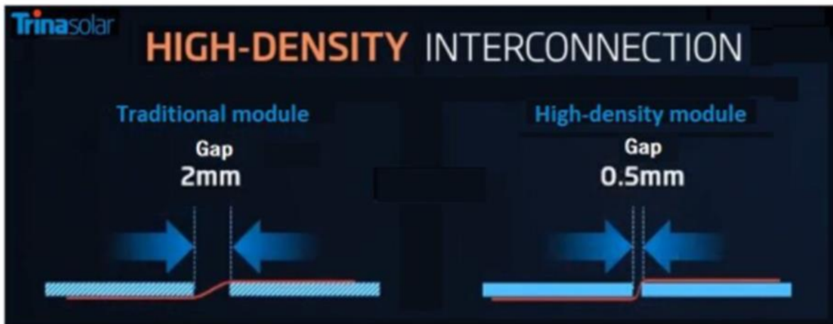
Σχήμα 2.8: Σχέδιο πλαισίου υψηλής πυκνότητας
