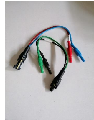
Σχήμα 3.1 Γ: Καλώδια και ακροδέκτες σύνδεσης οργάνων μέτρησης με τα φωτοβολταϊκά πλαίσια.
