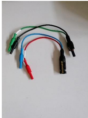
Σχήμα 3.1 Γ: Καλώδια και ακροδέκτες σύνδεσης οργάνων μέτρησης με τα φωτοβολταϊκά πλαίσια.
