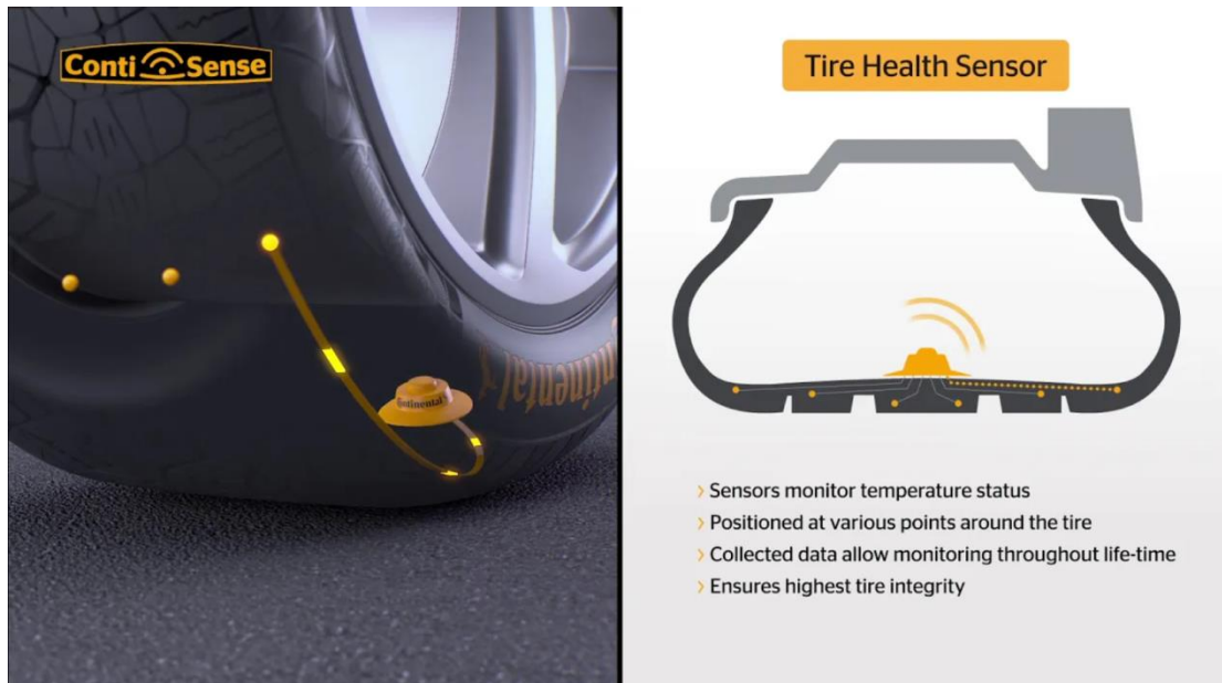
Εικόνα 15: Έξυπνα ελαστικά και οι λειτουργίες τους από την εταιρεία Continental [22]
