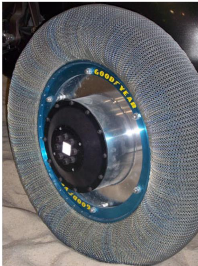
Εικόνα 17: Πλέγμα ελαστικού χωρίς αέρα της NASA[25].
