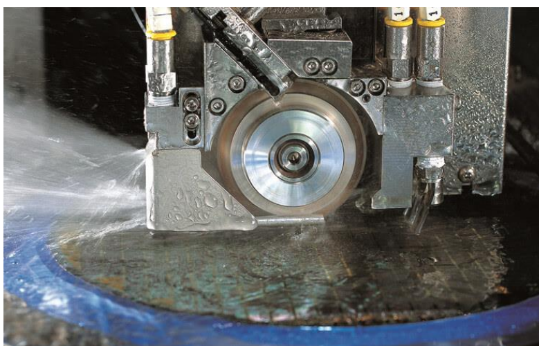
Εικόνα 3.8 Τεμαχισμός μητρών από wafer [47]
