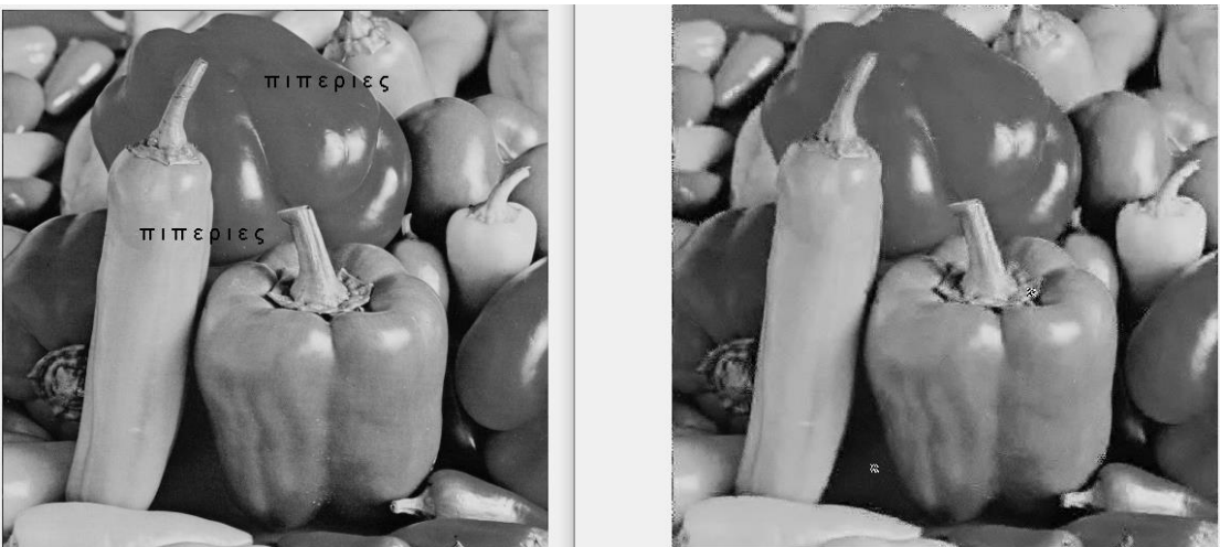
Εικόνα 5.15 Image_5 Inpainting με k -SVD σε grayscale εικόνα αφαίρεση τμημάτων, bb=8, overlap=3, J=3
