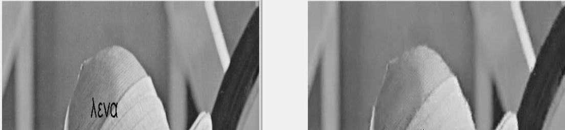
Εικόνα 5.13 Image_4 Inpainting με k -SVD σε grayscale εικόνα αφαίρεση τμημάτων, bb=8, overlap=3, J=3
