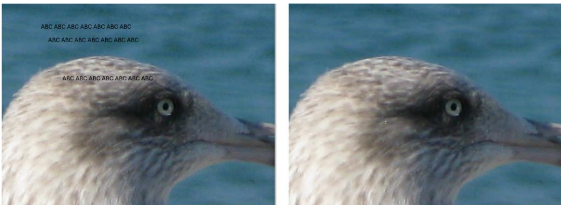
Εικόνα 5.5 Image_7 Inpainting με k -SVD σε έγχρωμη εικόνα(αριστερά αρχική εικόνα με γράμματα, δεξιά αποτέλεσμα αλγορίθμου) bb=8,overlap=3,J=3
