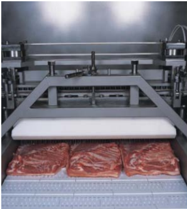
Εικόνα 10: Μηχάνημα έγχυσης άλμης με ειδικές βελόνες για παραγωγή μπέικον
