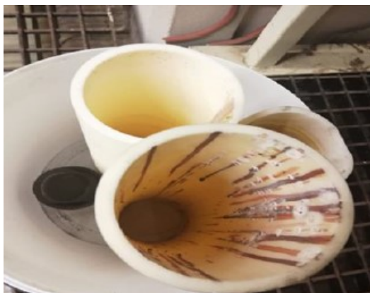
ΕΙΚΟΝΑ 12: Σωλήνες αλουμίνας που ράγισαν λόγω θερμικού σοκ [14]
