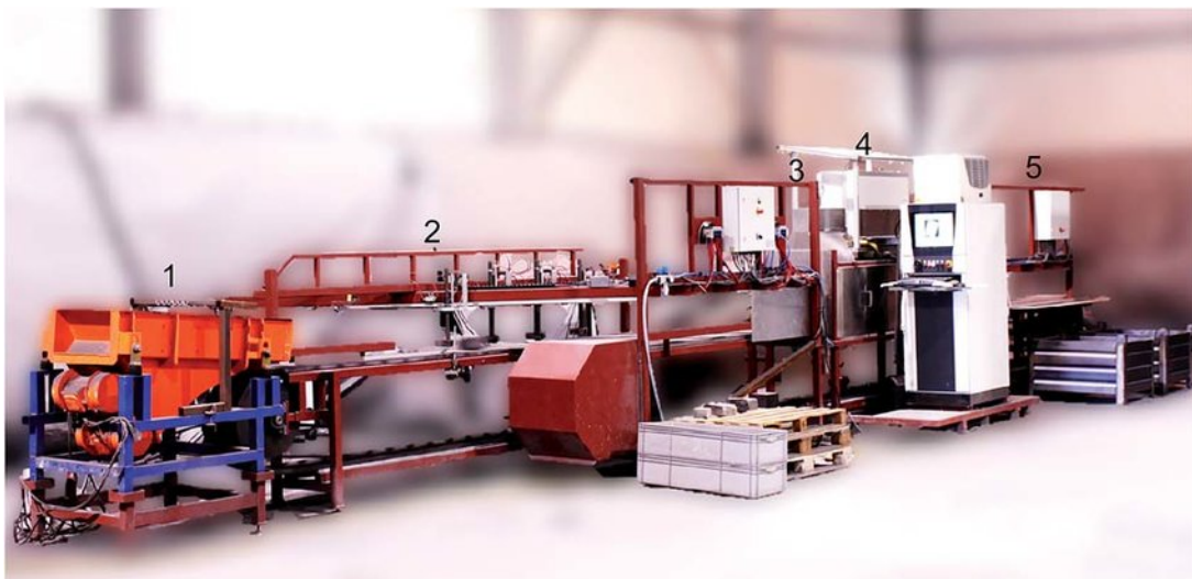
ΕΙΚΟΝΑ 13: Πρωτότυπο μηχάνημα διαλογής πυρίμαχων υλικών με ενσωματωμένη μονάδα LIBS, όπου 1) τροφοδοσία, 2) ενοποίηση, 3) κάμερα 3D, 4) μονάδα LIBS, 5) ταξινόμηση [15]
