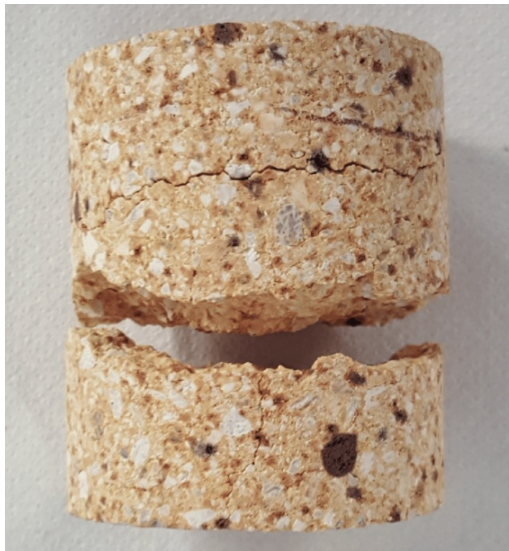
ΕΙΚΟΝΑ 10: Κυλινδρικό δοκίμιο μετά από θερμικό σοκ [10]
