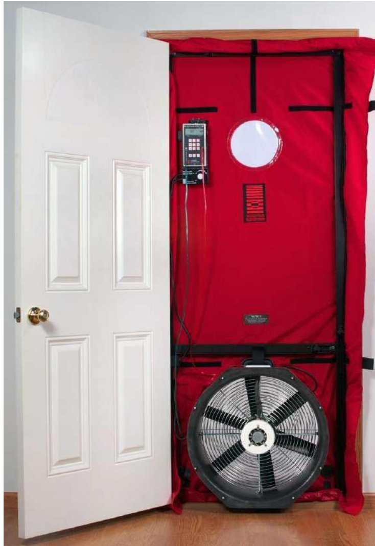
Εικόνα 5.6 Παράδειγμα εφαρμογής της δοκιμής "blower door test" [32]
