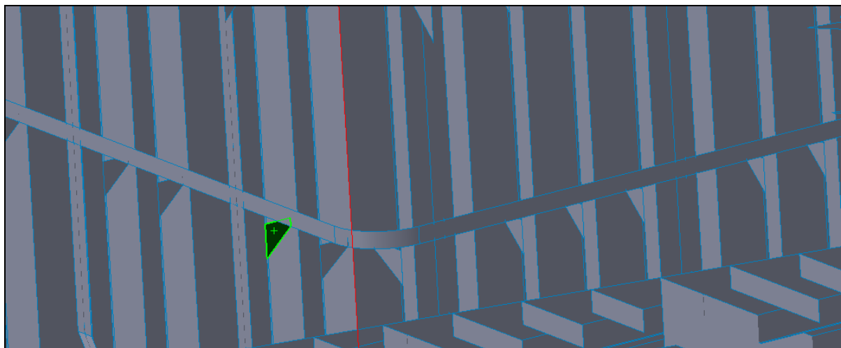
Εικόνα 66 - Αγκώνες σύνδεσης Upper Deck και Frame 8 κύριου ενισχυτικού
