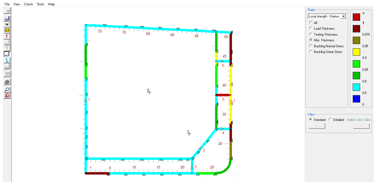
Εικόνα 39: Αποτελέσματα ελάχιστου πάχους ελάσματος (Minimum Thickness)
