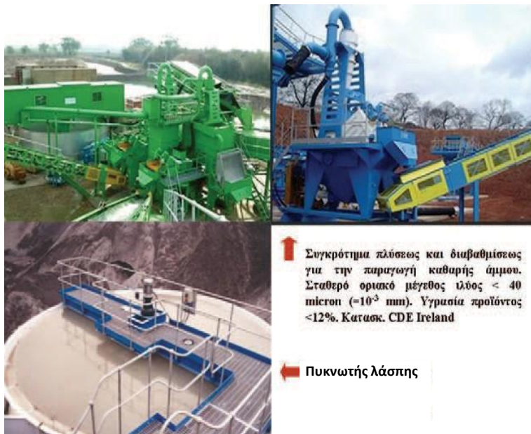
Εικόνα 3.8: Συγκρότημα πλύσεως & Μονάδα πυκνωτή λάσπης. Πηγή: https://www.cdglobal.com/applications/application-categories/sand-aggregates
