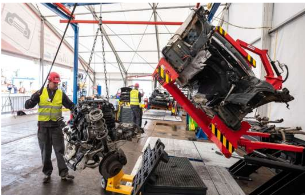
Εικόνα 4:Περιστροφή οχήματος και αποσυναρμολόγηση ανάρτησης, κινητήρα, κιβωτίου ταχυτήτων και του διαφορικού
