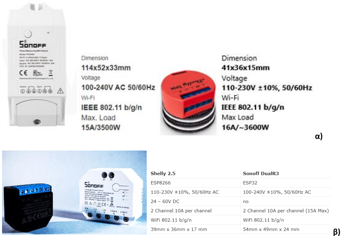
Εικόνα 2.2 Σύγκριση βασικών χαρακτηριστικών α) Sonoff POW R2 - Shelly 1PM και β) Shelly 2.5 -Sonoff R3
