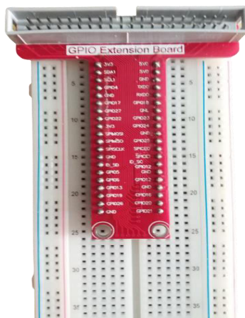
Εικόνα 4.24 GPIO πίνακα επέκτασης τοποθετημένος στην πειραματική διάταξη
