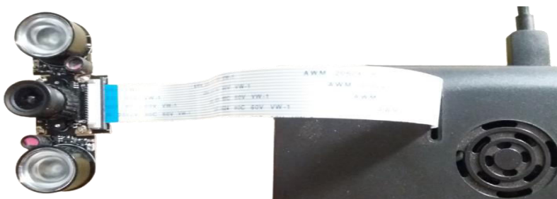
Εικόνα 4.23 Κάμερα συνδεδεμένη με την σειριακή διεπαφή κάμερας
