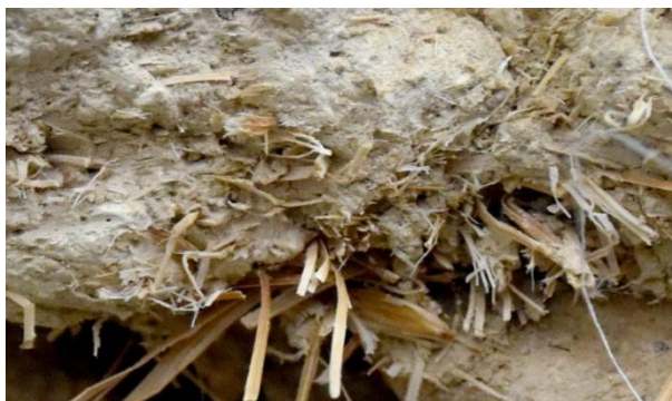
Εικ. 4: Ασβεστοκονιάμα με φυτικές ίνες
