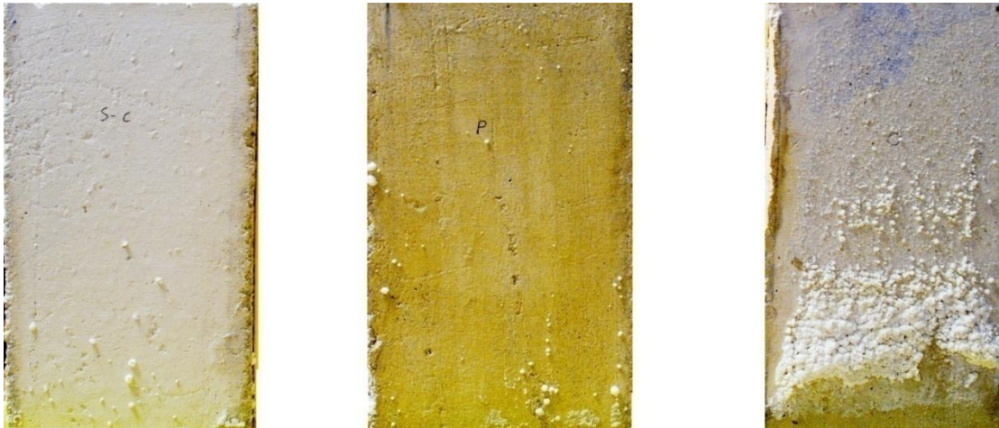
Εικ. 17: Από αριστερά προς τα δεξιά: Ατμοδιαπερατό υλικό υδροφοβίωσης, μη διαπερατή ακρυλική ρητίνη και μη επεξεργασμένο δοκίμιο
